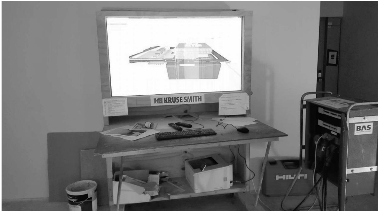
Figur 8: BIM-stasjon på byggeplass
