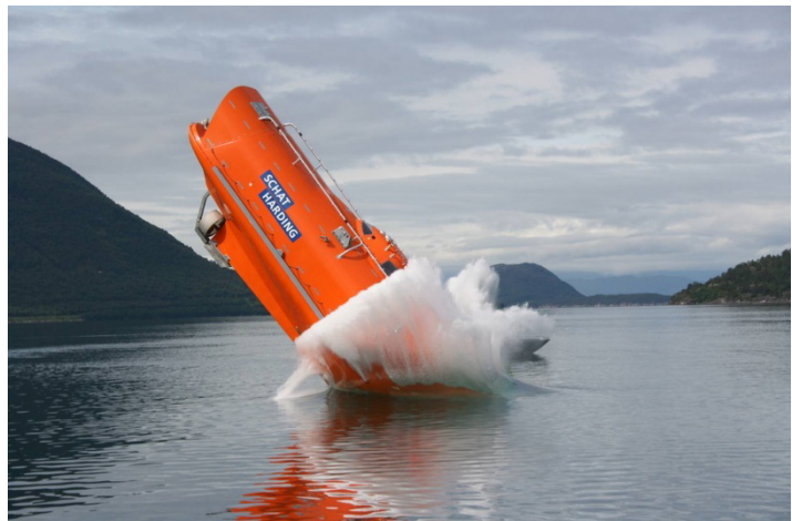
Figur 13 - FF1200 Stup - Foto: Safeiodfjell
