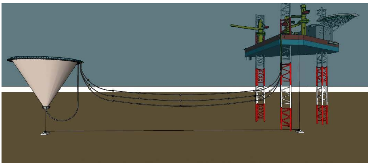
Figur 22 - De nedtrekkbare merdene er koblet til riggen med slanger for blant annet fôring og elektrisitet.
