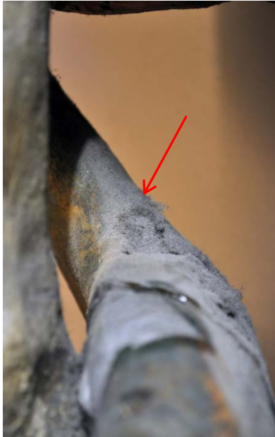
Figur 15) Tykt lag med overflatestøv på slangens hale.
