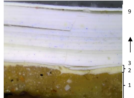
Fig. 42. Snitt av dørbladets malinglag.
