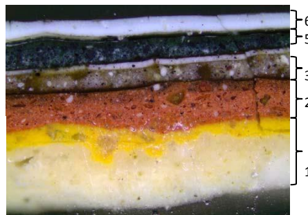
Fig. 62. Snitt av brannmurens malinglag. Det dekorative laget som del av lag 2 er ikke med i snittet.
