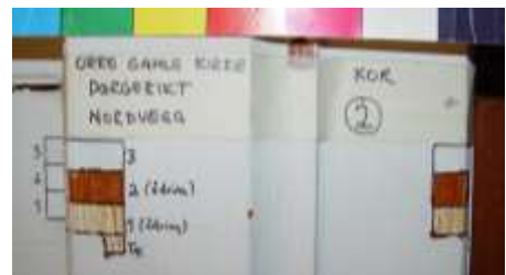
Fig.26. Fargetrapp på dørgerikt nordvegg i koret. I periode 1 og 2 har gerikten fulgt døren. I periode 3 følger gerikten vegg.
