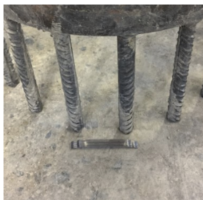
Figur 61 - Sammenligning av fiberlengde og armeringsavstand
