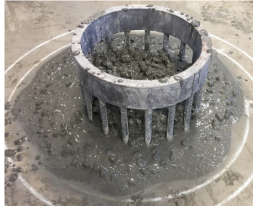
Figur 46 - Venstre: synkutbredelse med ring blanding fire, høyre: synkutbredelse med ring blanding syv
