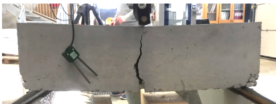
Figur 65 - Bjelke etter oppsprekking
