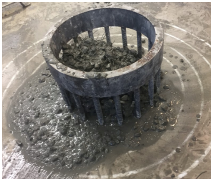
Figur 32 - Synkutbredelse med ring blanding fire
