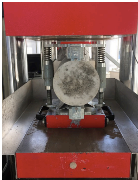
Figur 21 - Prøvestykke testes for spaltetrekk
