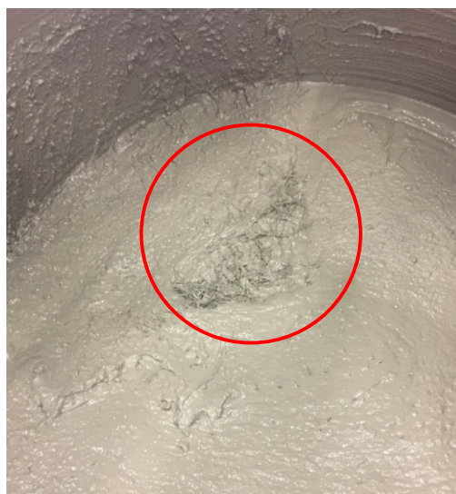
Figur 67 - Klump med fiber
