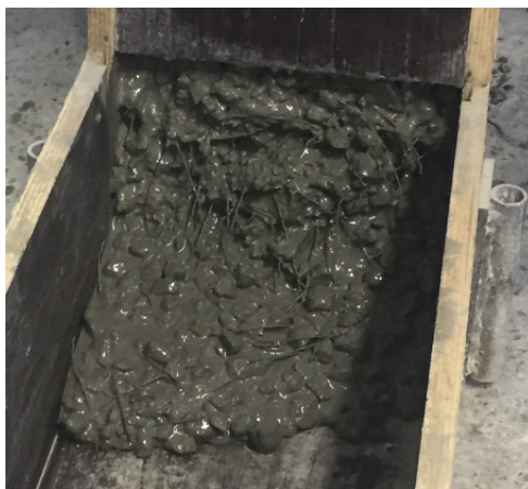
Figur 62 - Fiberen sperrer utgang, L-boks
