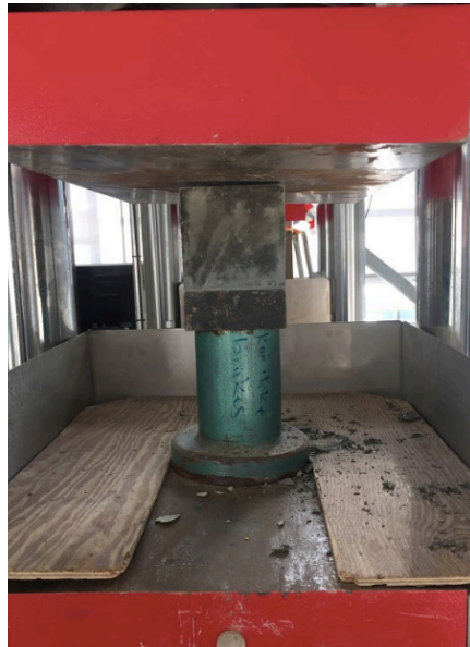
Figur 19 - Prøvestykke testes for trykkfasthet
