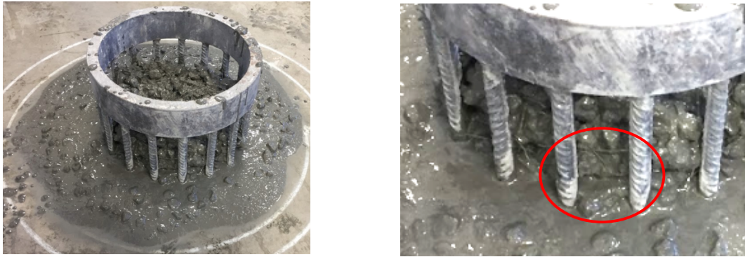
Figur 37 - Fiberen blokkerer, synkutbredelse med ring blanding syv
