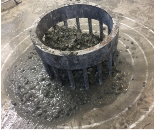
Figur 46 - Venstre: synkutbredelse med ring blanding fire, høyre: synkutbredelse med ring blanding syv
