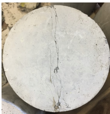
Figur 63 - Oppsprekking ved spaltestrekkfasthet
