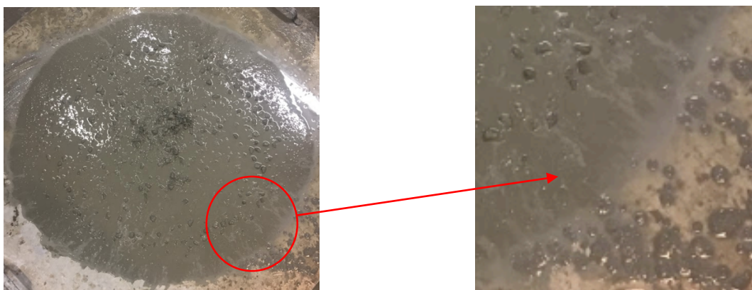
Figur 34 - Separasjon blanding fem
