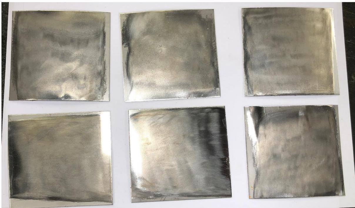
FIGURE 35: SAMPLES 2.4.X AND 3.4.X BAKSIDE TREATED WITH VALHALL CLEANGEL.
