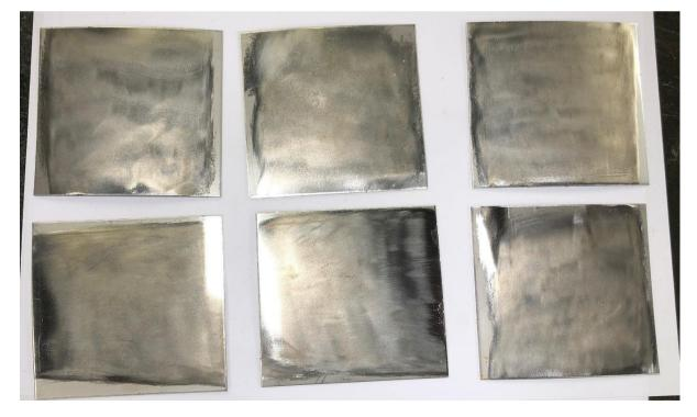
FIGURE 35: SAMPLES 2.4.X AND 3.4.X BAKCSIDE TREATED WITH VALHALL CLEANGEL.
