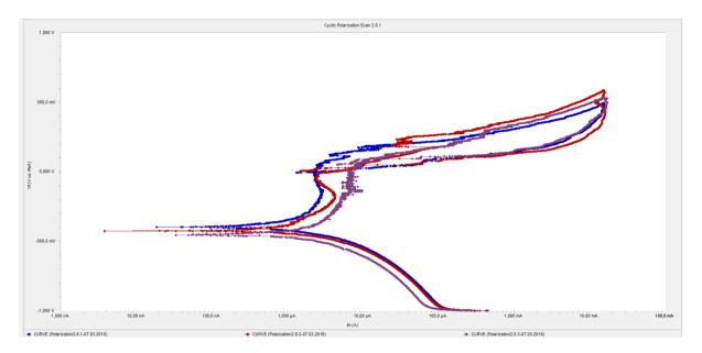
**FIGURE 65:** CYCLIC POLARIZATION CURVES FOR SAMPLES 2.8.X.
