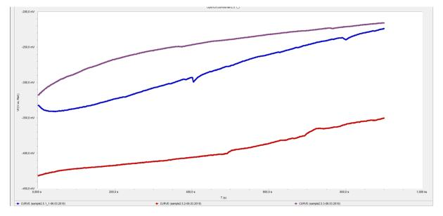
FIGUR 34: SAMPLE 2.5.1-2.5.3 OPEN CIRCUIT POTENTIAL GRAPHS.
