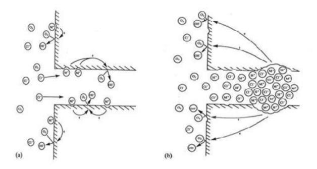
**FIGURE 5:**A) INITIAL CONDITIONS: OCCURS UNIFORM OVER THE SURFACE AND INSIDE THE GAP. B) FINAL CONDITIONS: OCCURS ONLY INSIDE THE CREVICE.[5]
