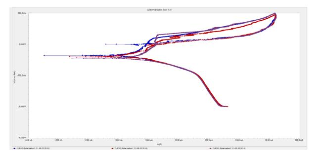
**FIGURE 52:** CYCLIC POLARIZATION CURVES FOR SAMPLES 1.3.X.
