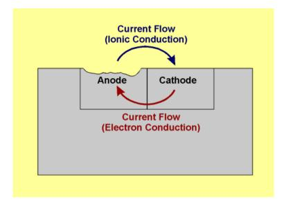
FIGURE 2: ELECTROCHEMICAL PROCESS. [10]
