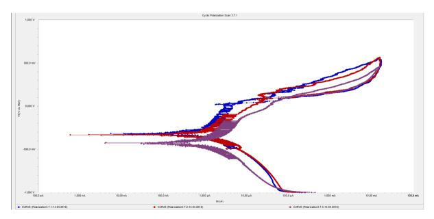
FIGURE 64: CYCLIC POLARIZATION CURVES FOR SAMPLES 3.7.X.
