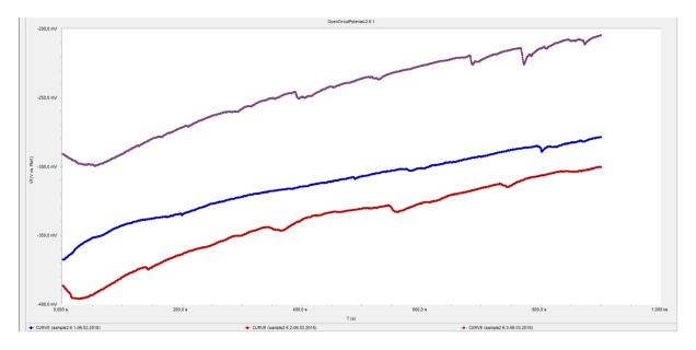
FIGUR 35: SAMPLE 2.6.1-2.6.3 OPEN CIRCUIT POTENTIAL GRAPHS.
