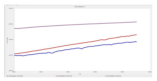
FIGUR 33: SAMPLE 2.4.1-2.4.3 OPEN CIRCUIT POTENTIAL GRAPHS.
