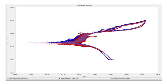
FIGURE 59: CYCLIC POLARIZATION CURVES FOR SAMPLES 2.5.X.
