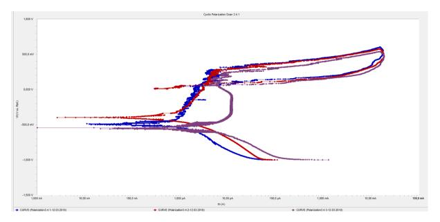
FIGURE 58: CYCLIC POLARIZATION CURVES FOR SAMPLES 3.4.X.
