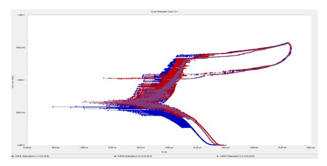
FIGURE 56: CYCLIC POLARIZATION CURVES FOR SAMPLES 3.3.X.
