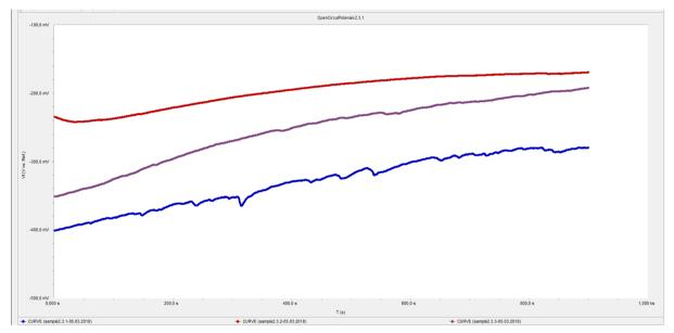
FIGUR 32: SAMPLE 2.3.1-2.3.3 OPEN CIRCUIT POTENTIAL GRAPHS.
