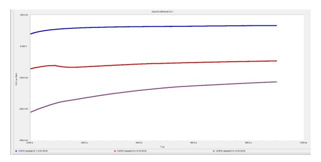
FIGUR 43: SAMPLE 3.6.1-3.6.3 OPEN CIRCUIT POTENTIAL GRAPHS.
