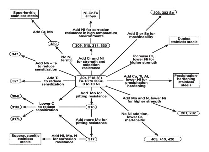
FIGURE 6: FAMILY TREE FOR STAINLESS STEEL ALLOYS.[15]
