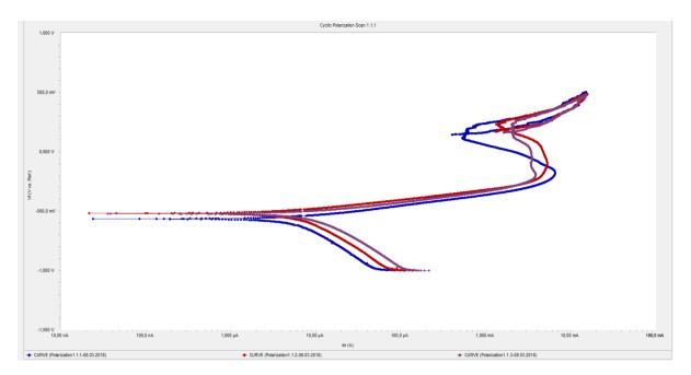
FIGURE 48: CYCLIC POLARIZATION CURVES FOR SAMPLE 1.1.X.
