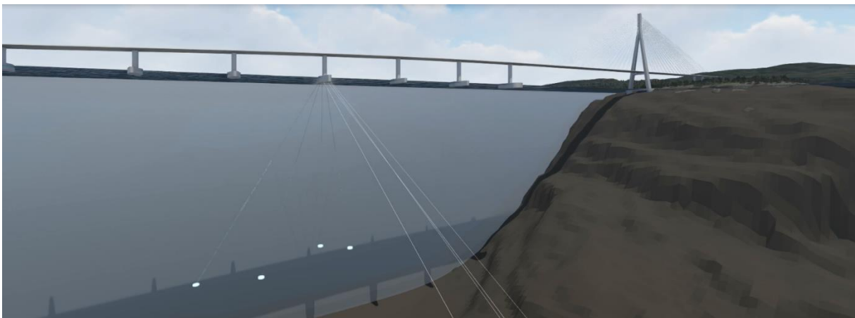
Figur 4.5: Illustrasjonen viser hvordan den sideforankrede flytebruen (K8) er festet til sjøbunnen med stålvaiere. Illustrasjon hentet fra Statens vegvesen (2018).
