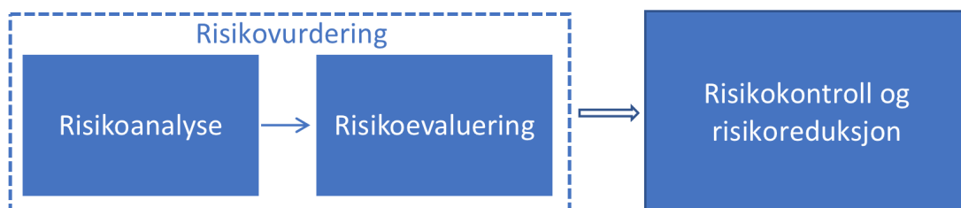
Fig. 4.11: Forenklet modell av de ulike elementene i risikostyring. Basert på Rousand & Utne (2009)[28]
