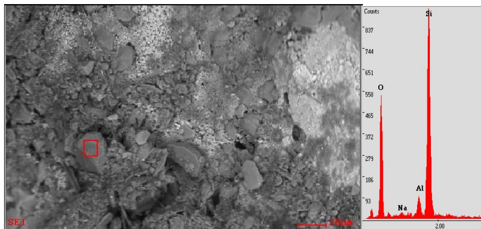
Figur 56: Et kvartskorn som ikke er omdannet til amorft glassmateriale. Dette tyder på at lokale områder av materialet ikke har vært utsatt for høye nok temperaturer.
