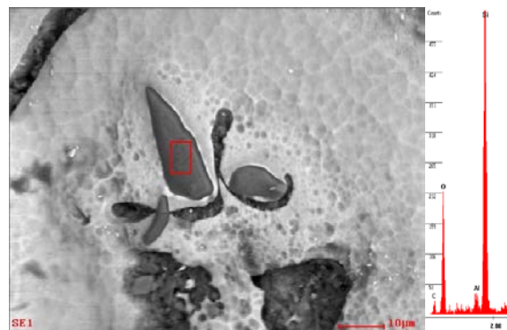
Figur 47: Et område av rent, smeltet glass, omgitt av bly og kobber i et gods av aluminiumsilikater.
