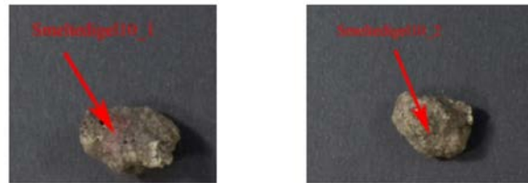
Figur 29: Punktene hvor det har vært gjennomført XRF-analyse på ulike områder av smeltingfragment 10.
