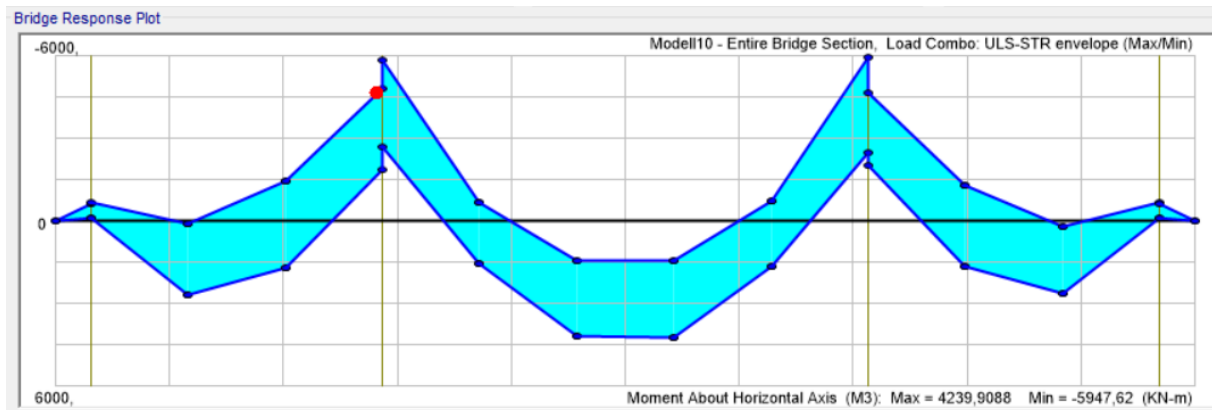
Figur 6.16 Bøyemoment for lastkombinasjoner i ULS. Modell 10
