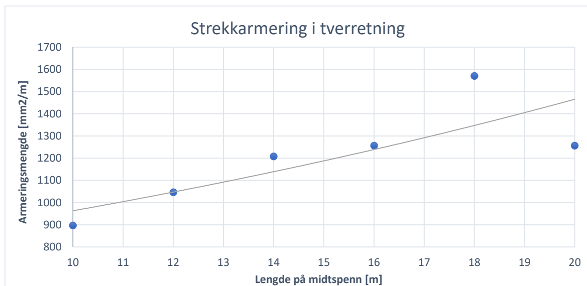
Figur 8.9 Strekkarmering i tverretning etter lengde på midtspenn
