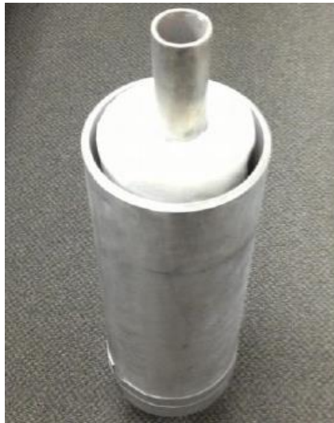
Figure 4. LNG marine double-pipe system (Nguyen, 2015).
