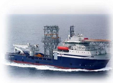
Figur 3 viser et DP- fartøy som kan installere CAN
