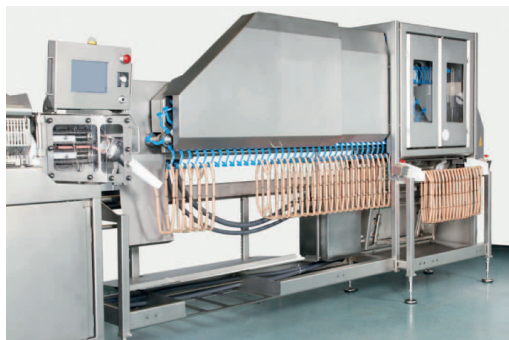
Figur 1.1. Marel iConveyor[19], maskin for å tre røykespyd i løkker av pølser
