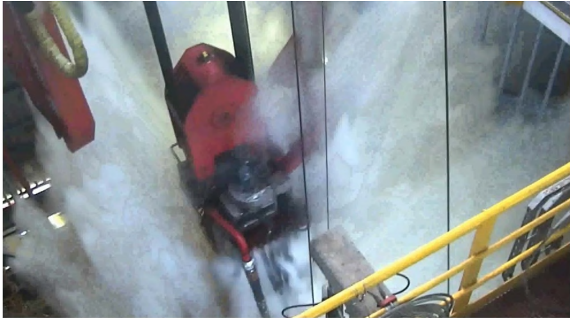
Gassutblåsningen fra toppen av fingerbordet i boretårnet (Ptil 2017a)
