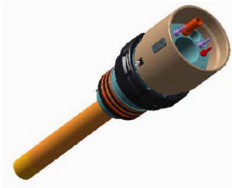
Tubing hanger har tilførsel til ringrom og hydraulikk til nedihullsventilene (Ptil 2017a figur 6)
