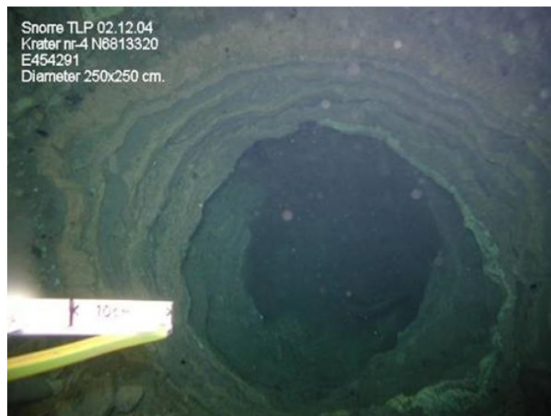
Store kratere på havbunnen og nære sugeankerne etter havbunnsutblåsningen på Snorre A
