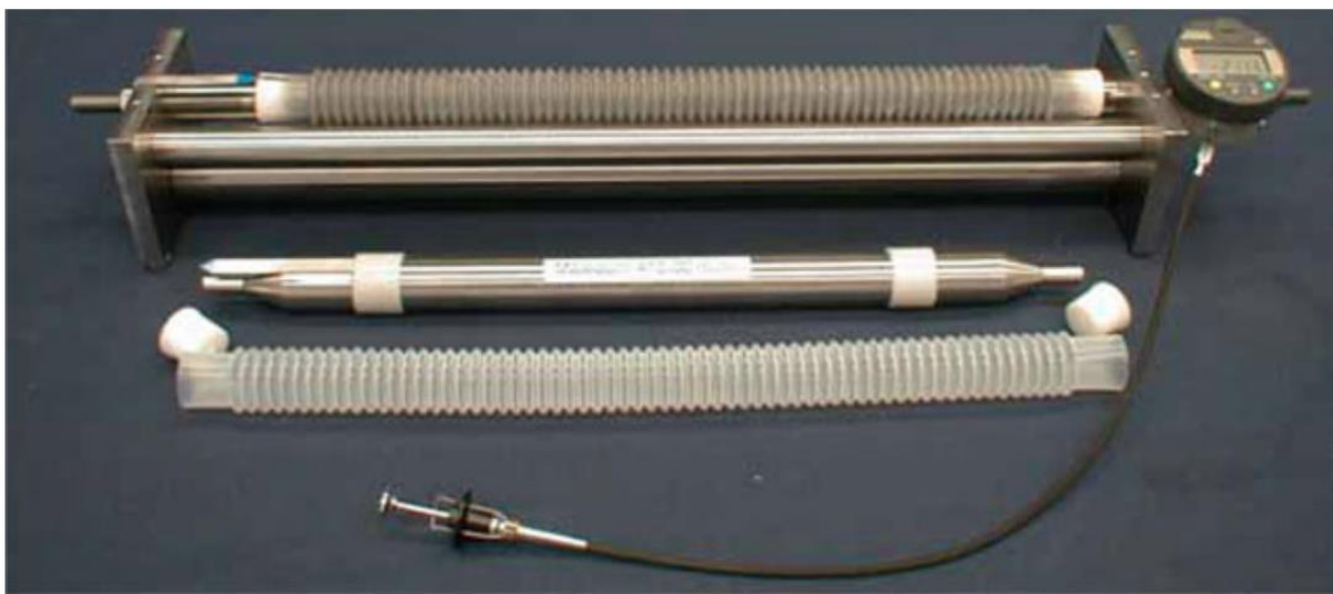
Figur 21 - Komponentene brukt i dilatometeret AS-systemet (bildet er funnet fra http://germann.org/products-by-application/autogenous-shrinkage/autogenous-shrinkage )
