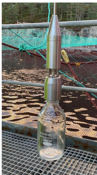
Figur 2.1.2 Vannhenter med lukket ventil.
