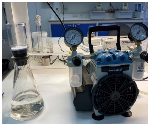
Figur 2.2.3. Filtrering av vannprøve. Oppsett for filtrering. Büchner flaske med filter i korken. Koblet til en vakuumpumpe med en silikonlange.
