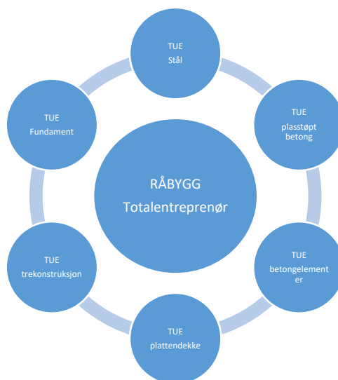
Figur 9. Råbygg oppdelt i flere totalunderentrepriser med et omfattende antall grensesnitt på tvers av fagene, med hensyn til prosjektering. I tillegg kommer byggherre, arkitekt og rådgivende ingeniør for byggteknikk.
