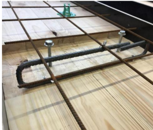
Figur 5.9: Detaljer av skjærforbindelse brukt av Crocetti og Jiang [18]
