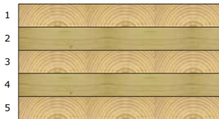
Figur 7.8: Illustrasjon av det aktuelle 5lags KLT-elementet [24]
