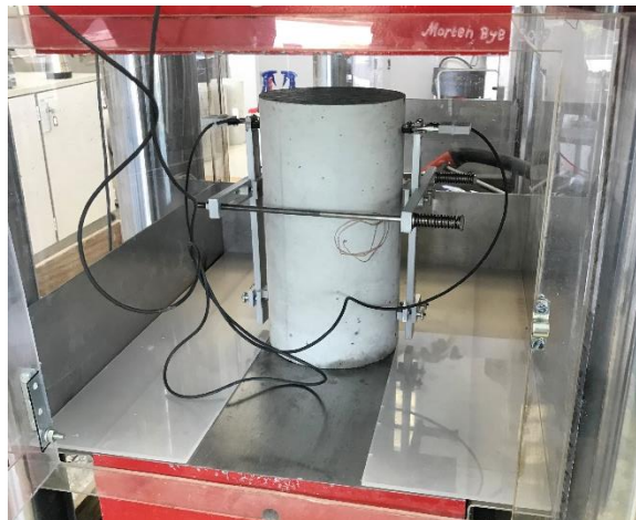
Figur 44. Test av elastisitetsmodul
