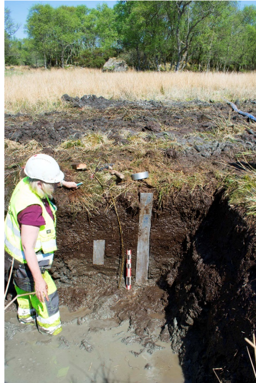
Figur 14: Prøvepunkt 16812 i sjakt 16800, foto mot N. Øverst: Før prøvetaking. Foto: C. E. Jensen Til høyre: Prøvetaking, kasseprøve 2016/03-5000 og -5001 er banket inn i sjakt-veggen. Provene – 5003 og -5004 er tatt under kassene. Person: C. E. Jensen. Målestokken langs kasse -5000 er 50 cm. Foto: E. D. Fredb
