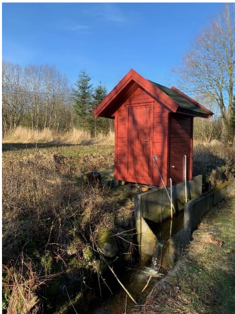
Figur 7: Viser målehytten som er utstyrt med v-løp som kan måle strømning. Hytten er også utstyrt med prøvetaker.
