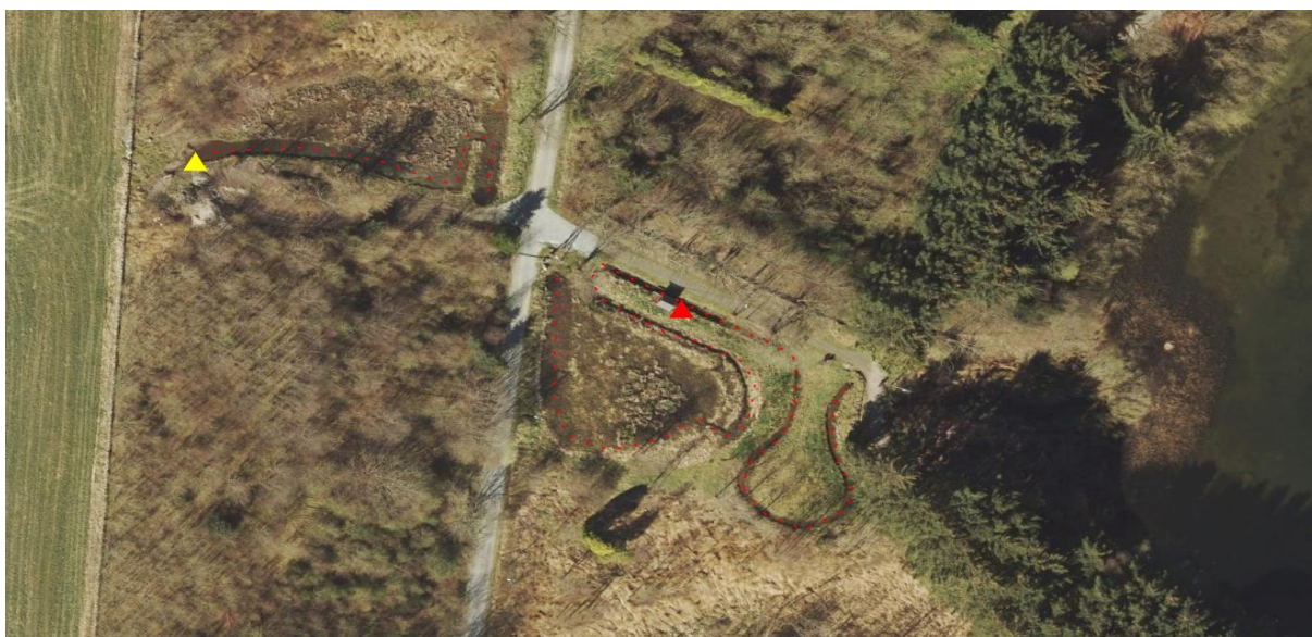
Figur 8: Oversiktsbilde av Leikvollbekken rensepark. Gul trekant viser hvor testvannet fra innløp ble hentet. Rød trekant viser hvor testvann utløp ble hentet. Stiplet linje viser vannets bane. (foto: kartverket)
