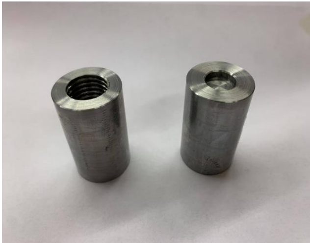
Figur 3.1.3: Ferdig maskinerte mellomstykker
