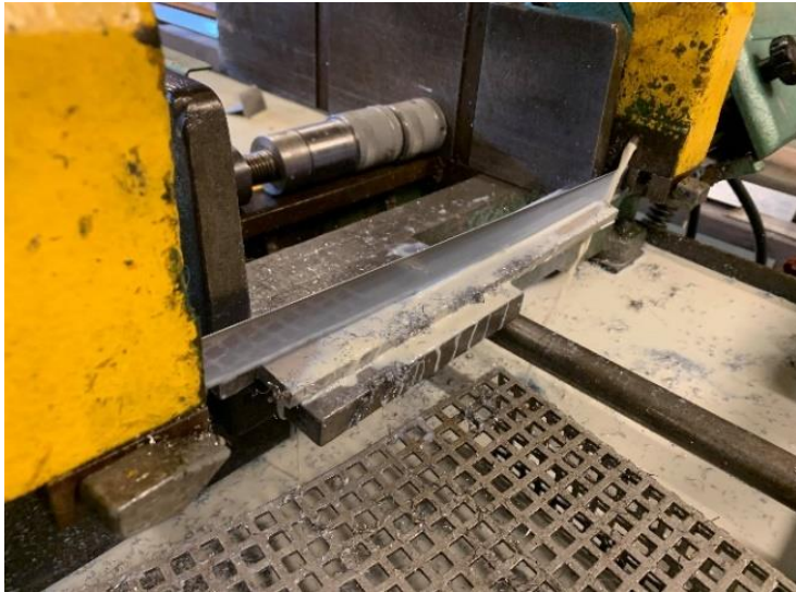
Figur 3.3.1A: Stav blir kappet ut av materialet ved bruk av rutch båndsg.
