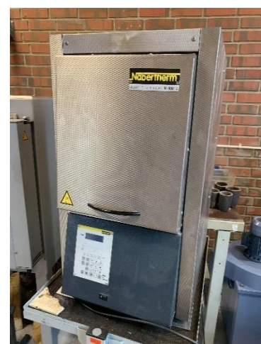
Figur 3.3.3B: Varmeovnen som ble brukt, Nabertherm HTCT 01/14.
