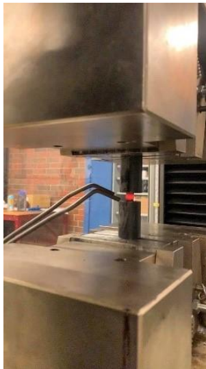
Figur 3.3.3C: Mellomstykkene står montert i kombimaskinen. Ett prøvestykke er under kompresjon.
