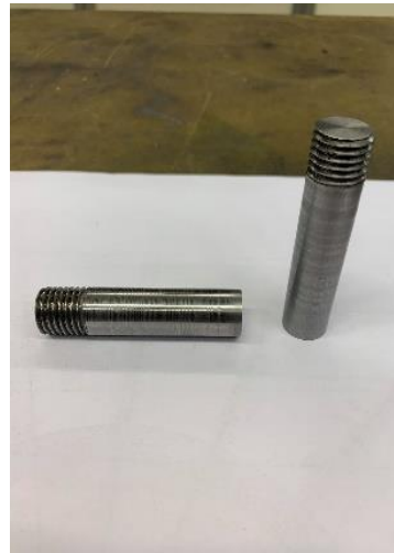
Figur 3.1.4: Ferdig maskinerte festebolter
