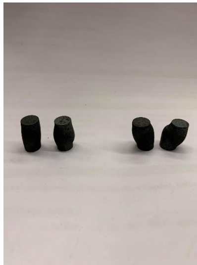
Figur 3.3.3D: Fire prøvestykker som er komprimert.
