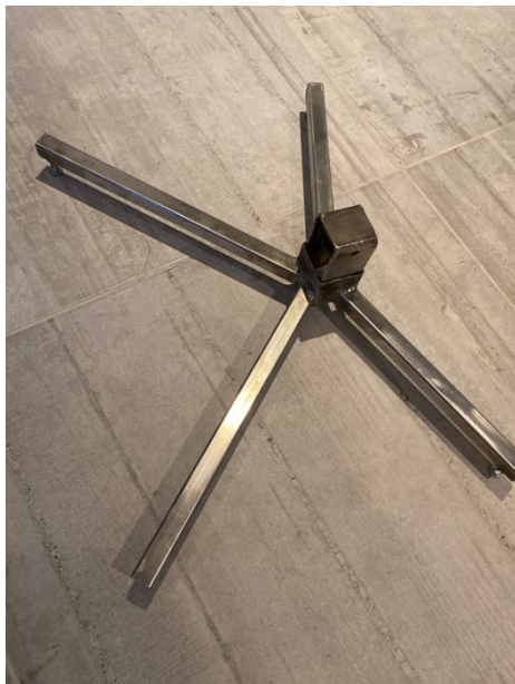
Figur 26a til venstre viser hoveddrammens for, 36b til venstre viser forten montert på hoveddrammen
