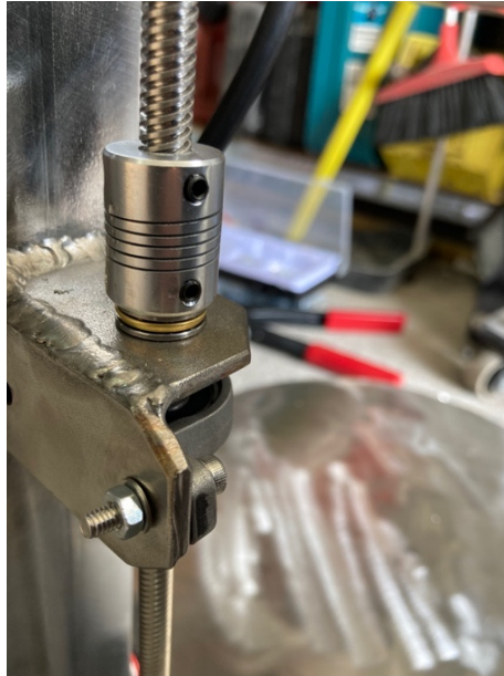
Figur 31a til venstre over viser robot prøvemontert 42b til venstre viser aksiallageret på trapsgjengestaget.
