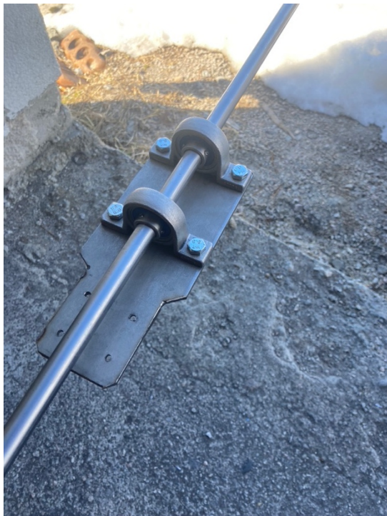
Plate for røretransportskrue og steppermotor brakett tilpasset og prøve montert sammen med lager og aksling til venstre ovenfor. Til høyre er platen heftet til hoveddrammens arm.
