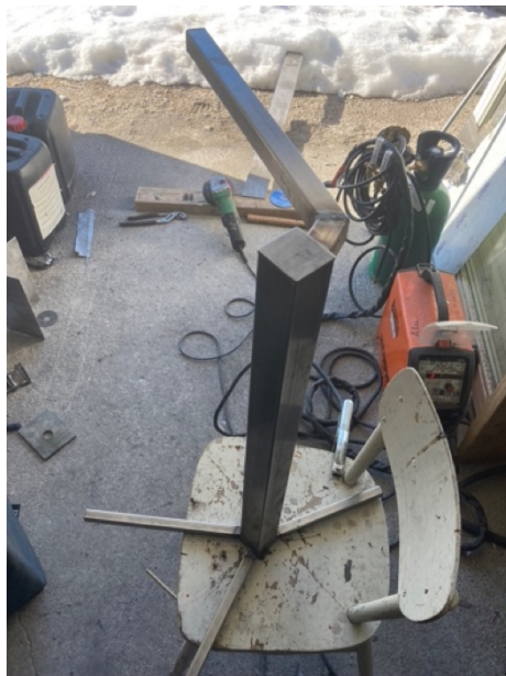
Figur 26a til venstre viser hoveddrammens for, 36b til venstre viser forten montert på hoveddrammen
