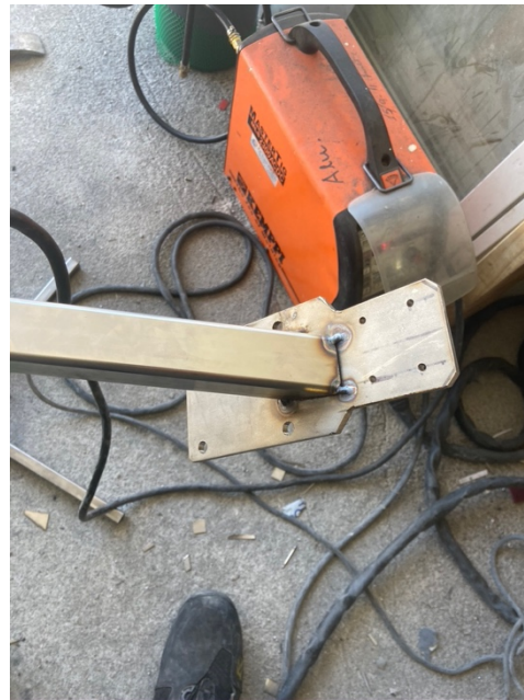
Plate for røretransportskrue og steppermotor brakett tilpasset og prøve montert sammen med lager og aksling til venstre ovenfor. Til høyre er platen heftet til hoveddrammens arm.
