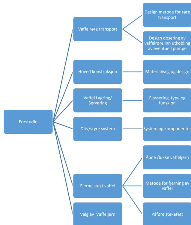
Figur 1 Forstudie nedbrutt i vaffelrobotens hovedelementer
