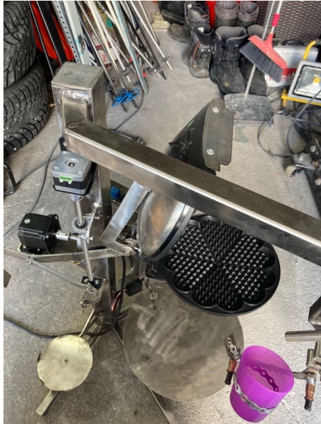
Figur 31a til venstre over viser robot prøvemontert 42b til venstre viser aksiallageret på trapsgjengestaget.
