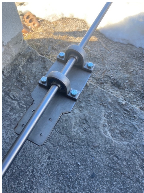
Figur 28a til venstre viser en ferdig hovedramme 39b til høyre viser prøvemontering aksling til røretransport
