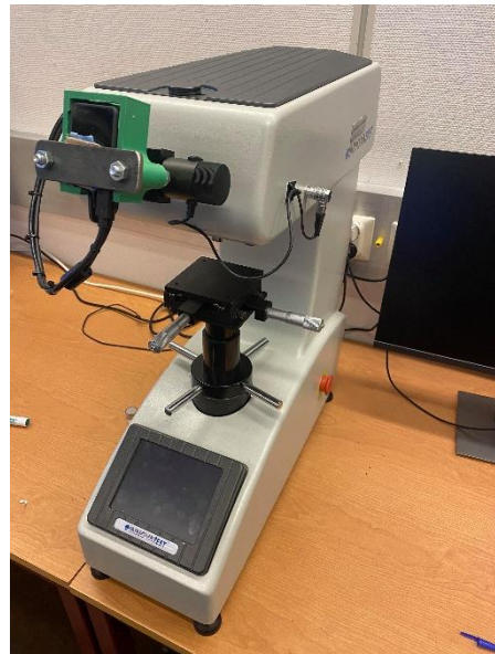
Figur 3.9: Innovatest, hardhetstesteren brukt
