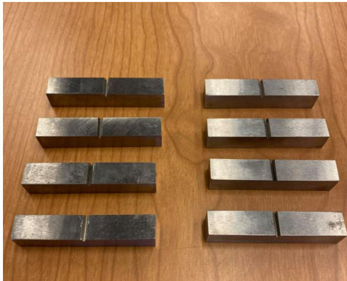
Figur 3.7: Skårslagsprøvene ferdig maskinert
