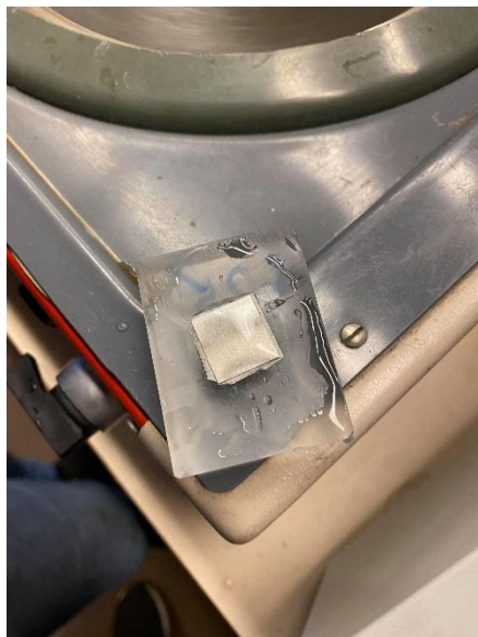
Figur 3.5: TEM-prøve limt med tape på kloss
