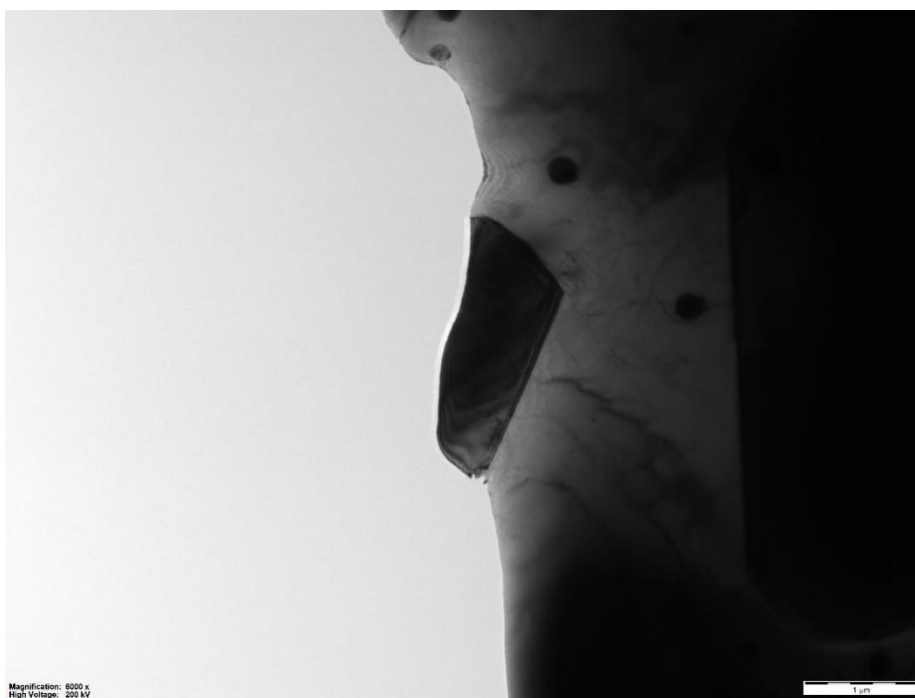
Figur 4.14: Transmisjonselektronmikroskop bilde av austenitt
