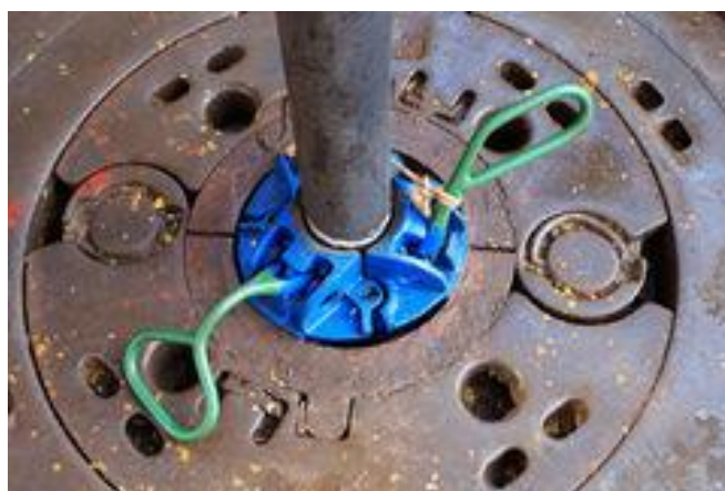
Figur 2.1 - Manuelt slips installert rundt borestrengen i boredekket [4]
