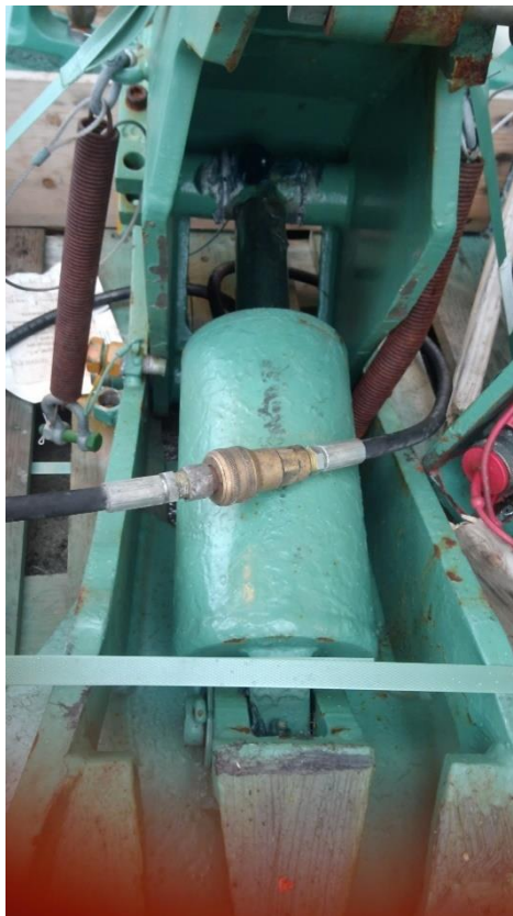
Figur 3.8 - Dobbeltvirkende sylinder på pneumatisk slips, A.Kongshaug
