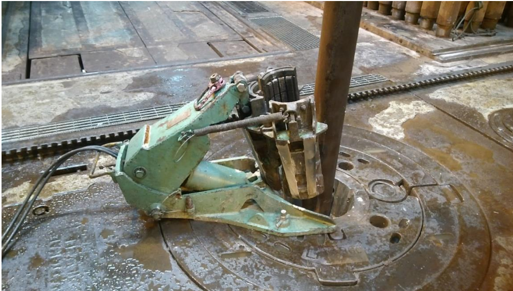
Figur 2.4 - Pneumatisk slips installert på boredekk, A.Kongshaug
