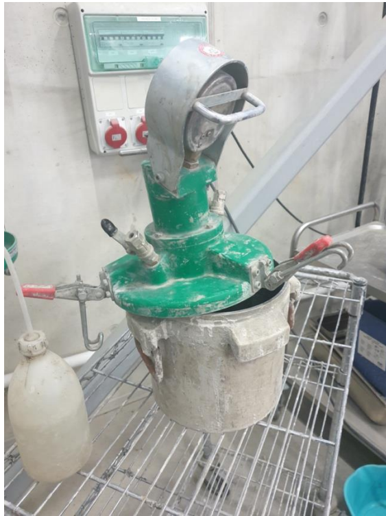
Figur 13 a/b: Luftprøvingsapparat og illustrasjon over luftprøvingsapparat
