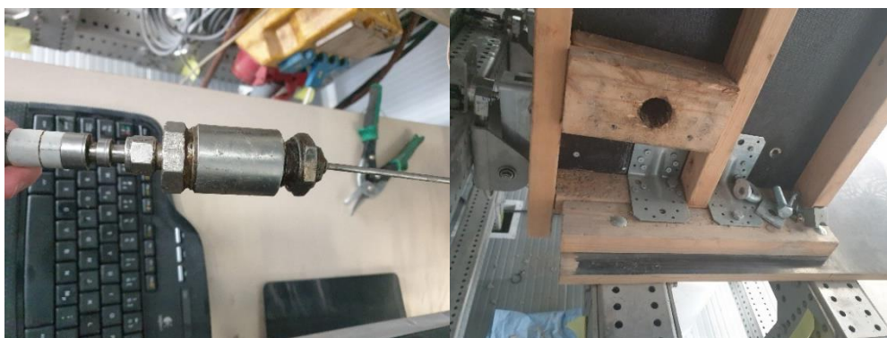
Figur 20 a/b: Poretrykksmåler med påmontert nål. Holder for poretrykksmåler i betongbeholder.
