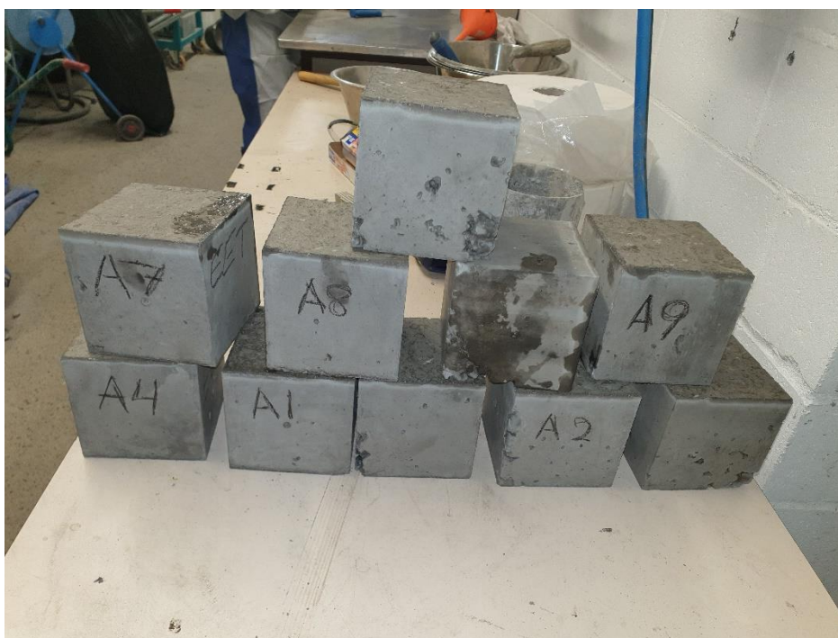
Figur 23: Prøveterninger med mangelfull komprimering (SF6)
