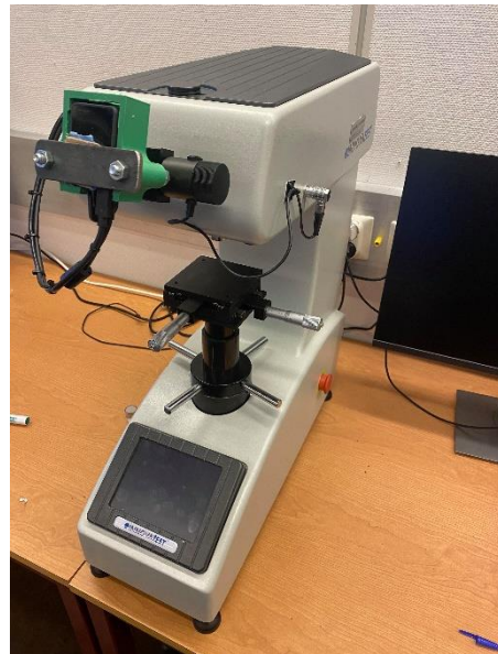
Figur 3.9: Innovatest, hardhetstesteren brukt
