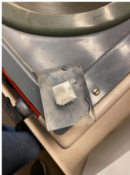
Figur 3.5: TEM-prøve limt med tape på kloss
