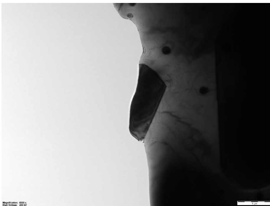
Figur 4.14: Transmisjonselektronmikroskop bilde av austenitt
