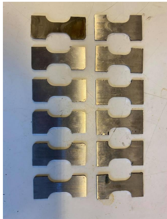
Figur 3.8: Strekktester i byggeretning og normalt på byggeretning
