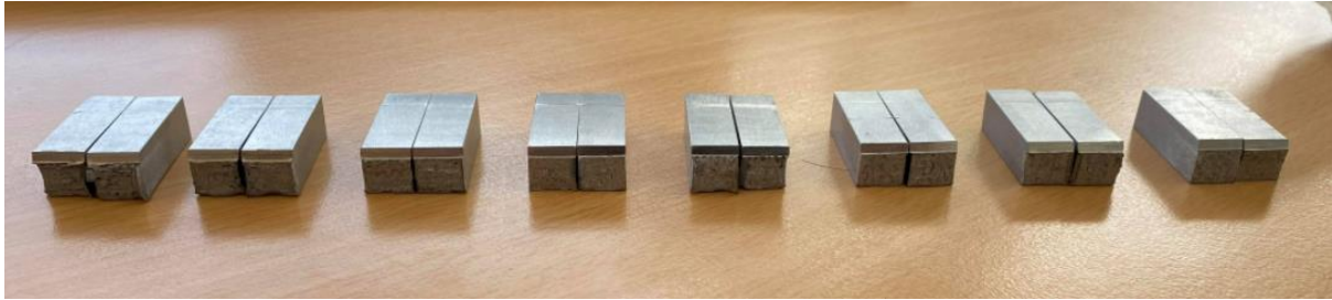
Figur 4.7: Bruddoverflatene til skårslagsprøvene, sett fra venstre: C1, C2, C3, C4, B1, B2, B3 og B4
