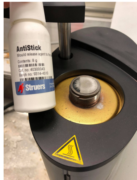
Figur 17: Antistick til Citopress-30.
