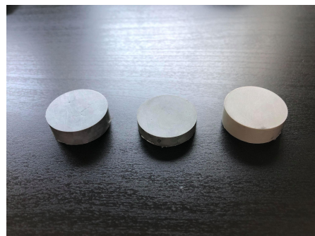
Figur 19: Prøver for mikroskop med slipt side opp.
