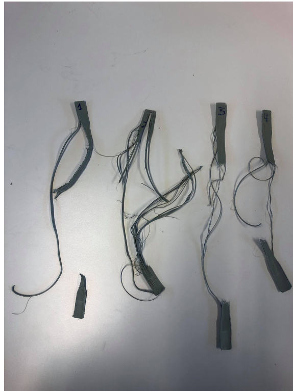
Figur 35: LDPE strekktest prøver etter test
