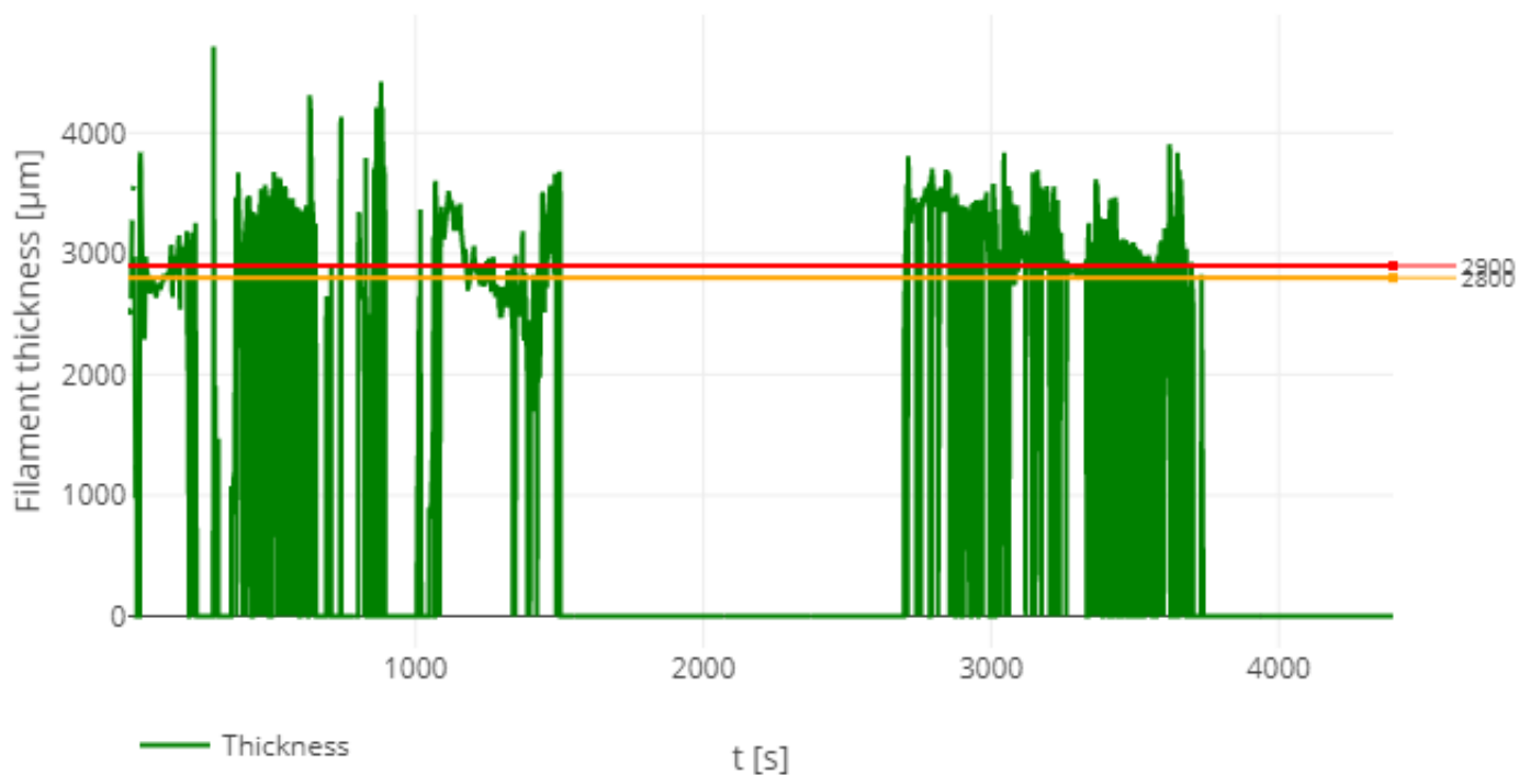
Figur 25: PP med vanlig kjøling - Filament diameter i forhold til tid anløpt
