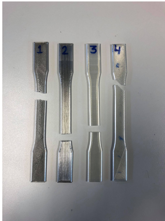
Figur 34: PLA strekktest prøver etter test
