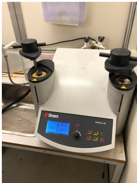
Figur 16: Citopress-30 maskin for støping av mikroskop prøver.
