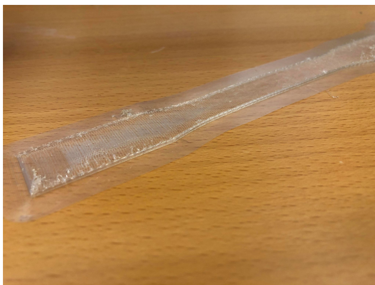
Figur 33: Ufullstendig print av PLA strekktest prøve
