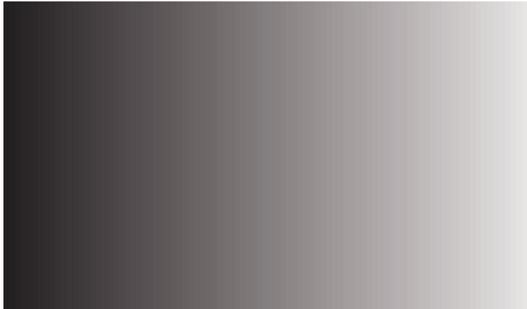
Figur 5.4: Ark som brukes for å simulere måling av temperatur ved hjelp av lyssensoren til EV3en. De mørke områdene har lav refleksjon og gir dermed lave verdier fra lyssensoren; disse områdene representerer lav temperatur. De lyse områdene har høy refleksjon og dette gir høye verdier som da representerer høy temperatur.
