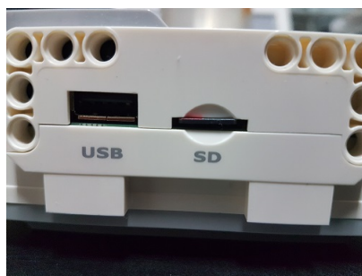
Figur 2.2: SD-porten på EV3en med et microSDHC kort installert.
