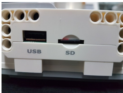
Figur 2.19: USB-porten på EV3en hvor det kobles til en styrestikk.
