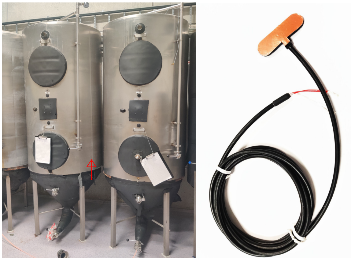
Figur 3.7: Fotografi av overflatesensor og melketank. Rød pil viser montasjested for sensoren. Fotograf: Vegard Jaatun.
