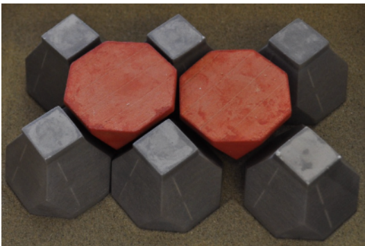
Figur 24: Originalstein etter påført belastning. Hentet fra [3, side 46].
