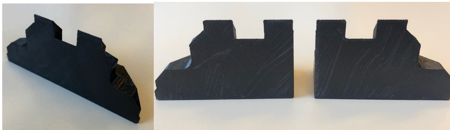
Figur 102: 3D-print kantavslutning 2, 4, og 3.
