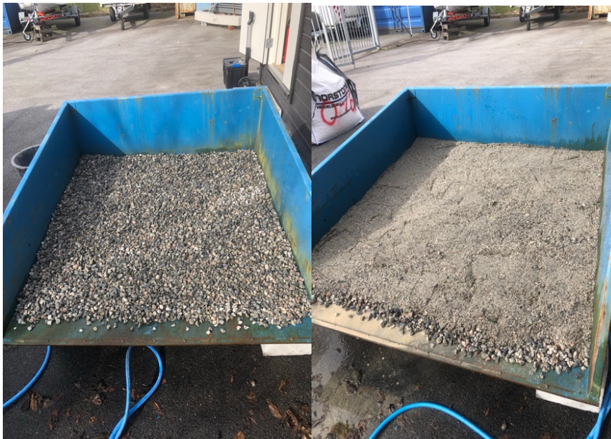
Figur 115: Grov tilslag under, og fint tilslag over.
