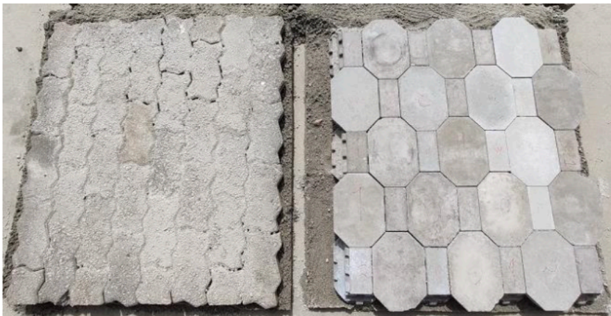
Figur 42: Dekke etter test, ingen synlige endringer. S-stein til venstre og S01 til høyre.
