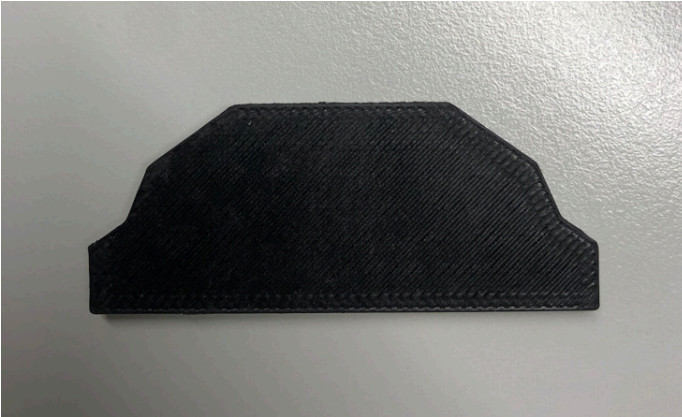
Figur 97: 3D-print brikke til justering.
