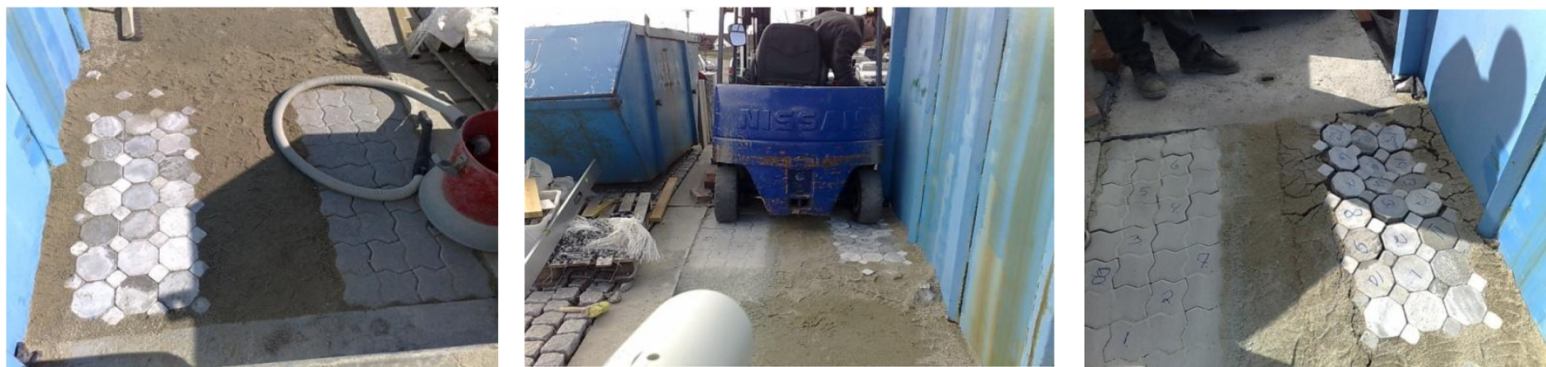
Figur 2: Før, underveis, og etter påføring av last. Vist på originalstein og vanlig belegningsstein Hentet fra [2, side 8].
