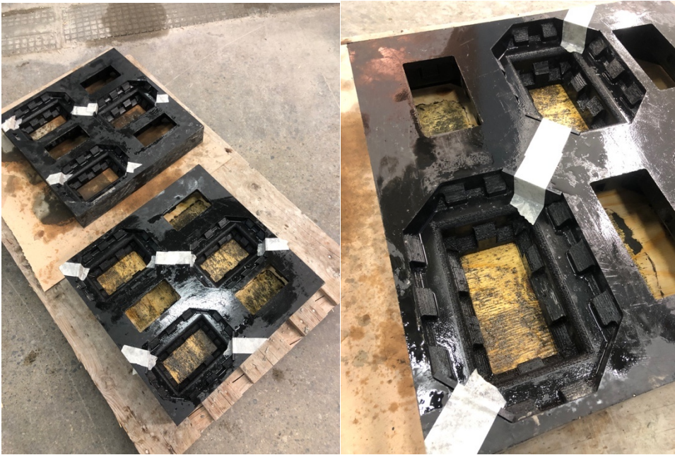
Figur 110: Former klargjort til støping.
