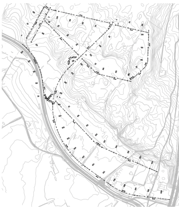
Figur 34 Linjeføring for modellering av veger i Novapoint (kilde: produsert i AutoCAD)
