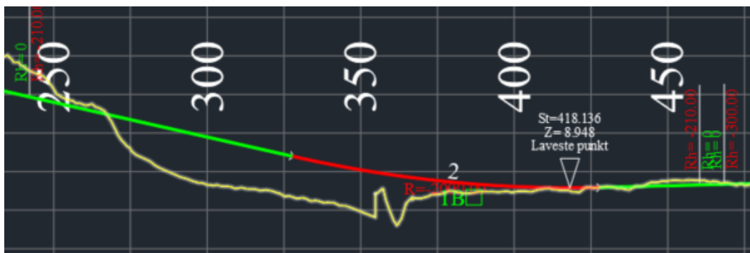
Figur 36 Konstruksjon av vertikolgeometri for VEG10000 i Autocad (kilde: produsert i AutoCAD og Novapoint)
