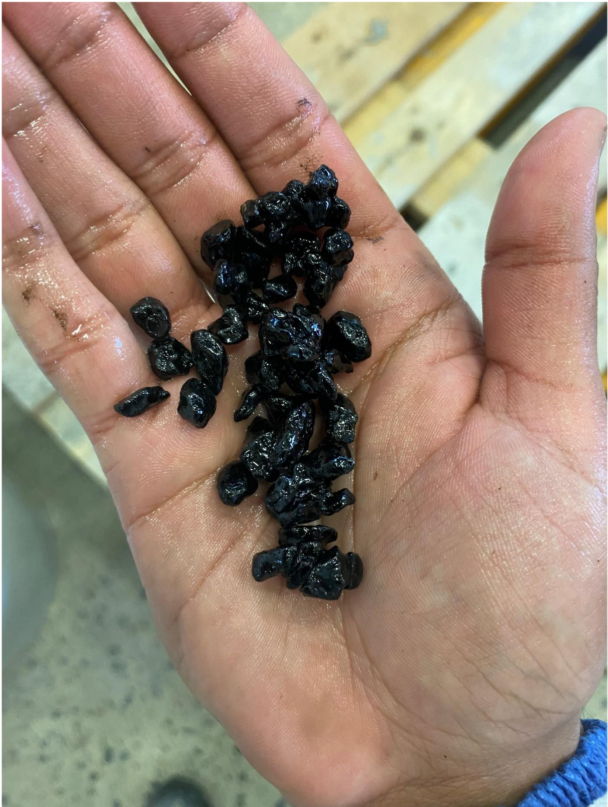
Figur 35: Resultat av bitumenperler laget med steinmateriale
