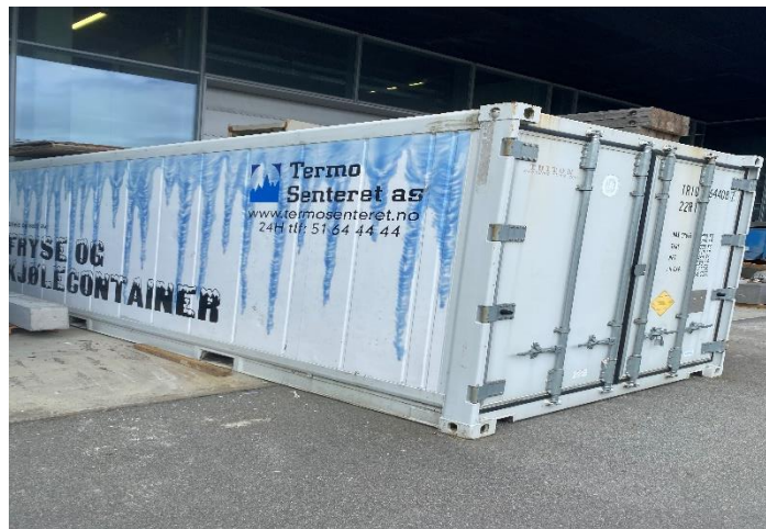
Figur 30: Kjølecontainer som kjøler ned betongklosser til is
