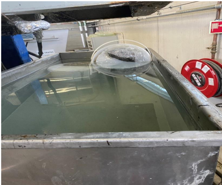
Figur 19: Betongklosser kjølt i kjølecontainer i vannkar med iskaldt vann
