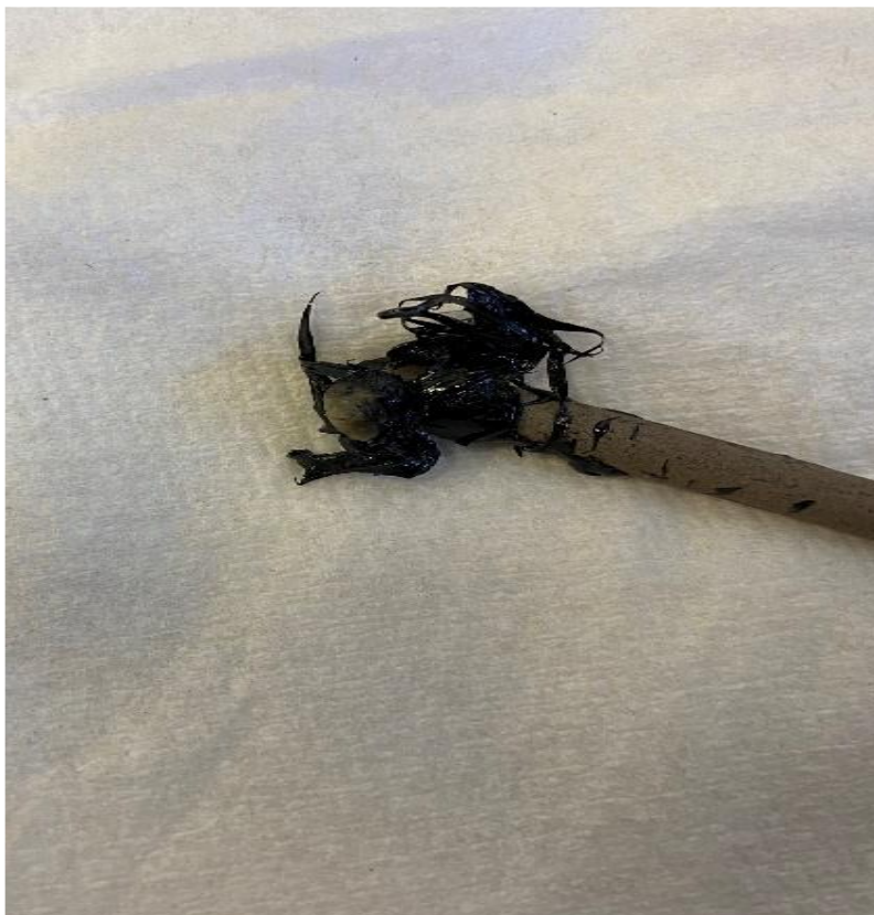
Figur 33: Heftprøve av steinmateriale
