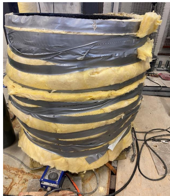
Figur 13: Isolering av fat
