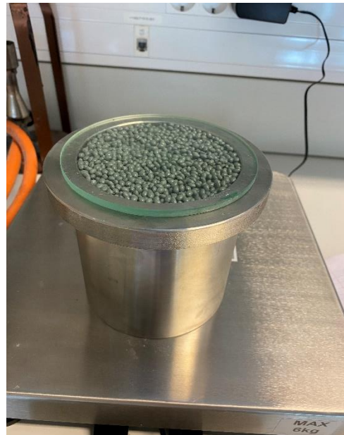
Figur 8: Pyknometer med plastikkpellets og glassplate som veies for å finne densitet
