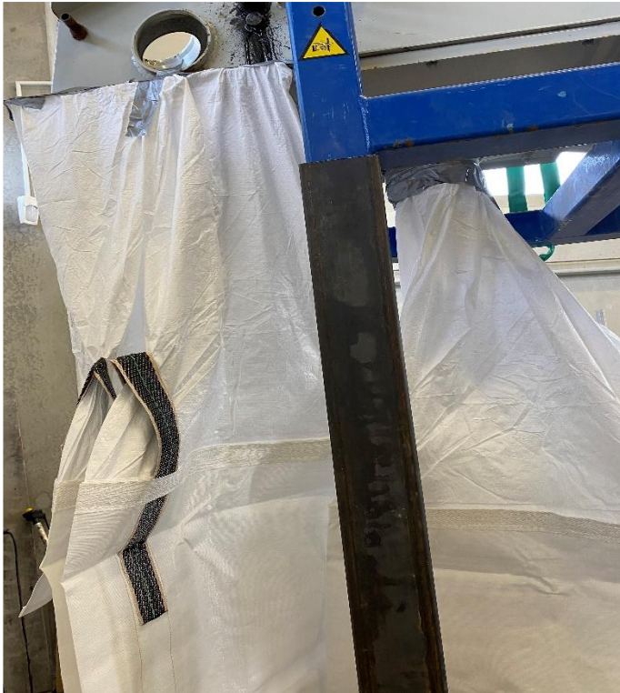
Figur 28: Store plastsekker som dekker siktemaskinens åpninger
