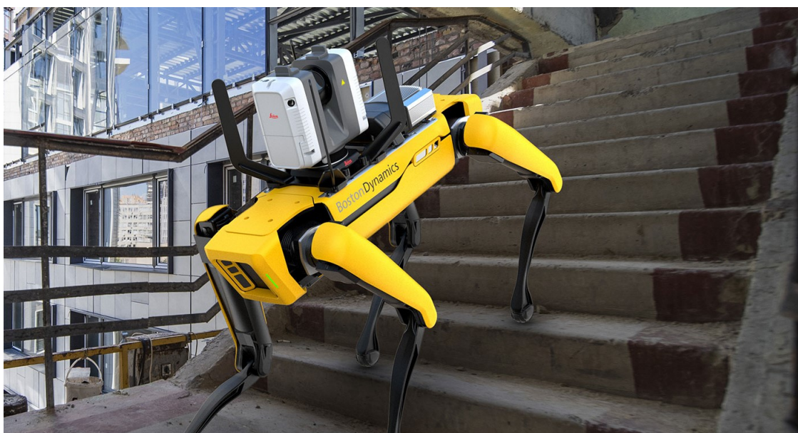
Figur 6.4.: Boston Dynamics Spot tilkoblet en Leica scanner. Hentet fra (Leica Geosystems, 2021).
