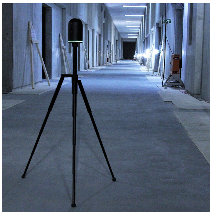
Figur 4.6.: Leica BLK360 skanner festet på stativ (ground-fixed). Hentet fra (Bjørheim, 2019).
