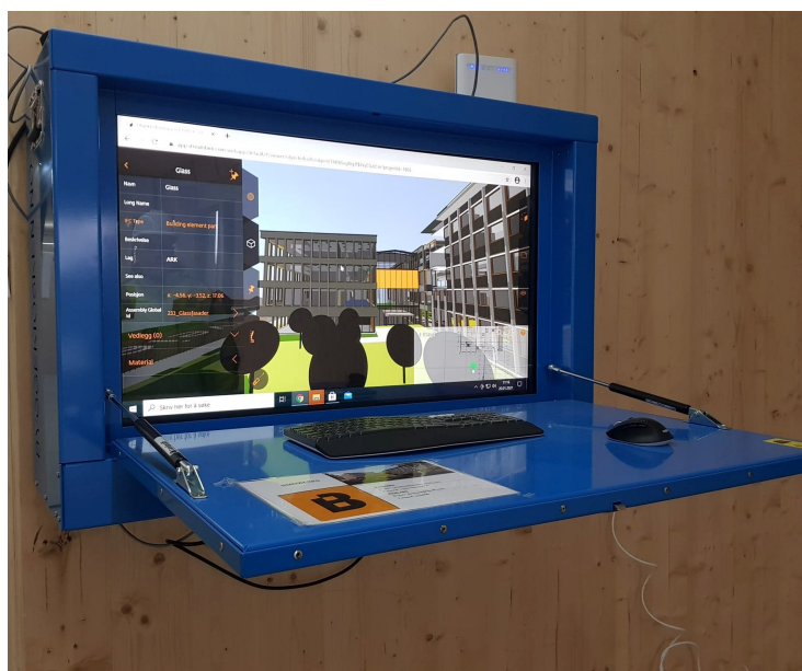
Figur 3.5.: BIM kiosk montert på vegg. Bilde tatt fra Lyse Elnett prosjektet på Sandnes.
