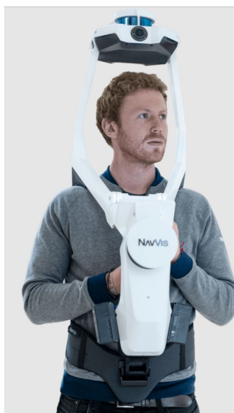
Figur 6.6.: NavVis VLX wearable mapping device. Hentet fra (NavVis , u.d.).
