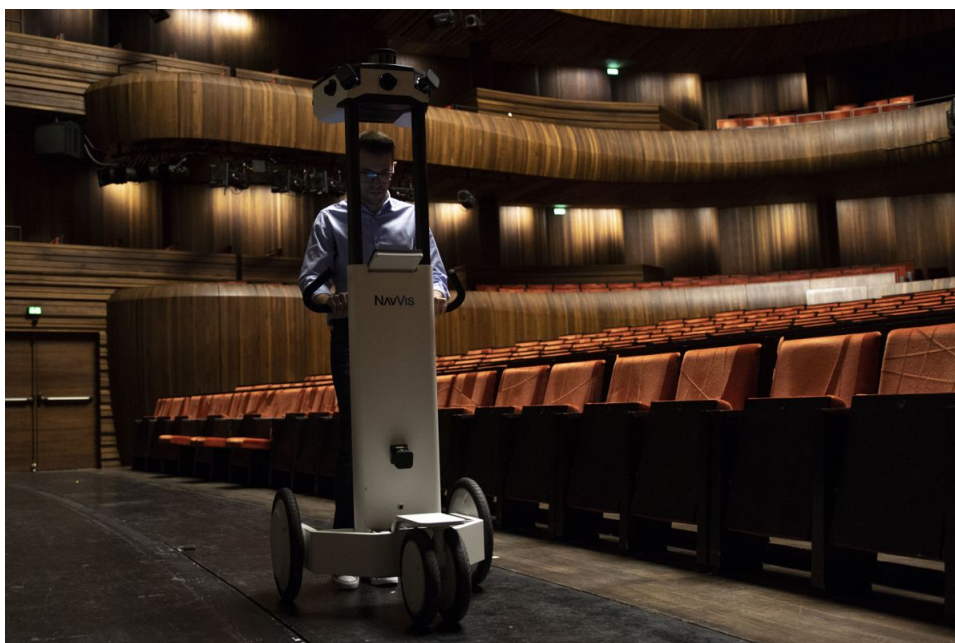
Figur 6.5.: NavVis Indoor mapping Trolley kartlegging-system levert av Geograf Digital. Hentet fra (Blakstad, 2018).
