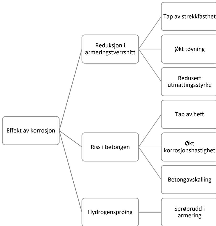
Figur 4: Konsekvenser av korrosjon [5, kap. 16.1 fig. 16.1]
