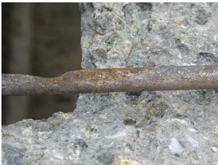
Figur 10: Groptæring på armeringsstang fra Hafrsfjord Bru [18, 10/7 2001]
