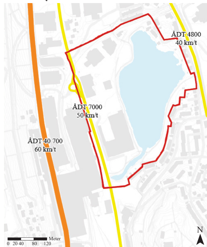
Figur 107: Trafikkmengden målt i årsdøgntrafikk (ÅDT) og fartsgrense (km/t) for de fleste trafikerte vegene i planområdet med tall hentet fra 2019. Egenprodusert basert på (Statens vegvesen, u.å.)
