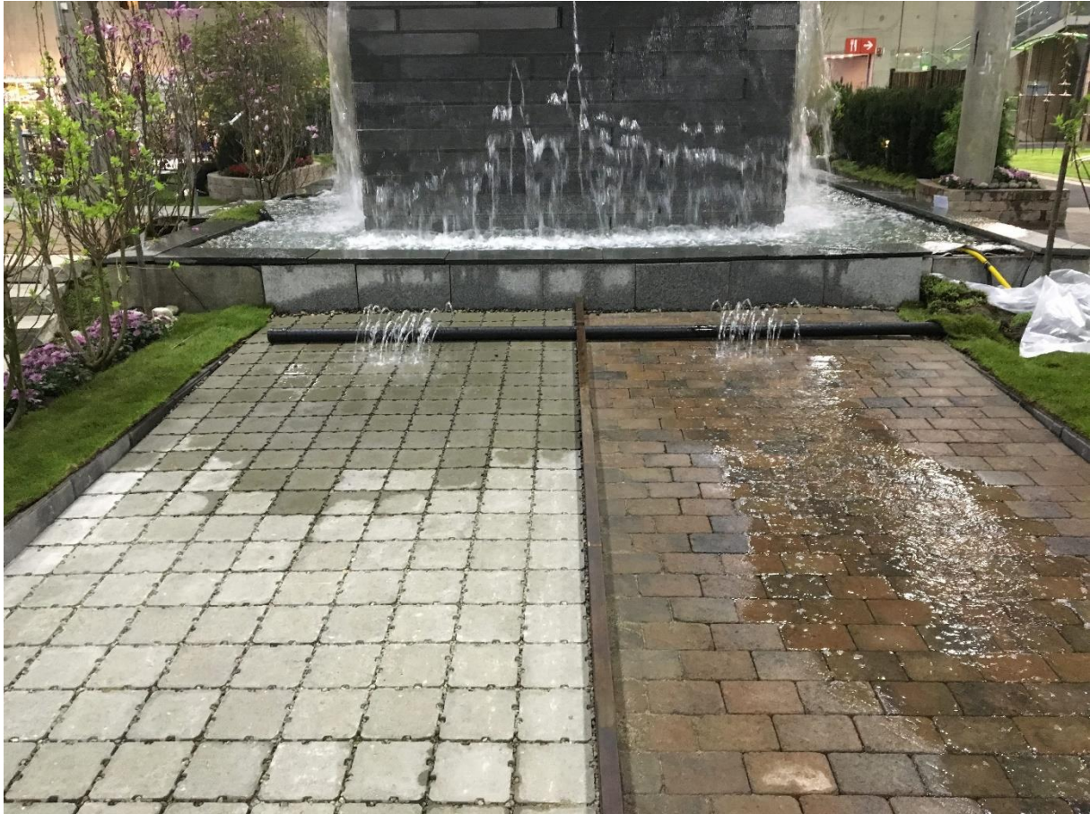
Figur 3.8: På venstre side er det anvendt et permeabelt dekke, mens på høyre sider er det tett dekke. Fra: Permeable dekker med belegningsstein i betong håndterer overvann, (Sivertsen, Muthanna, & Time, 2018), Foto: ASAK Miljøstein,
