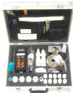
Figur 24: Feltanalyse sett til RCT-metoden.
