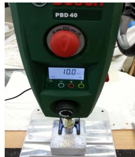
Figur 43: Utfresing av betongsstøv
