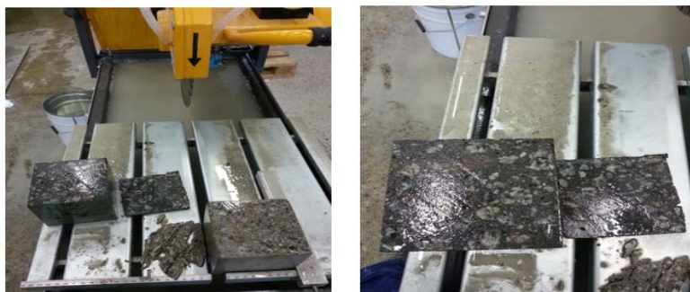
Figur 48: Diamantsag (t.v.) og prøvestykketoverflate etter forbehandling (t.h.).
