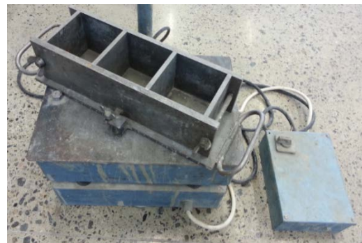
Figur 33: Terningsform oppå en vibrasjonsmaskin
