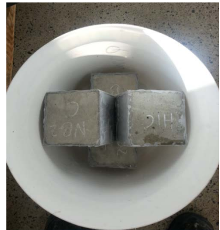
Figur 42: Prøvestykker klargjøres til saltbad.
