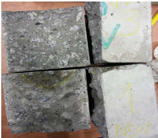
Figur 70: Sammenligning mellom betong typene for vanninntrengningsprøven
