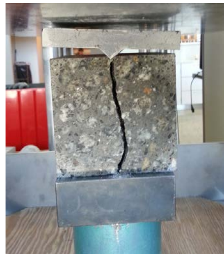
Figur 50: Prøvestykke splittes i to.
