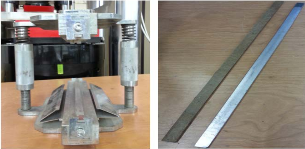
Figur 38: Utstyr til spaltestrekkfasthetsprøve: Stativ (t.v) og mellomlegg lister av tre og stål (t.h.)
