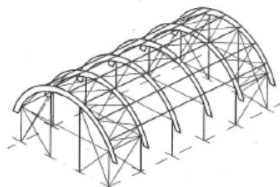
Figur 97 – Bæresystem for tak i haller
