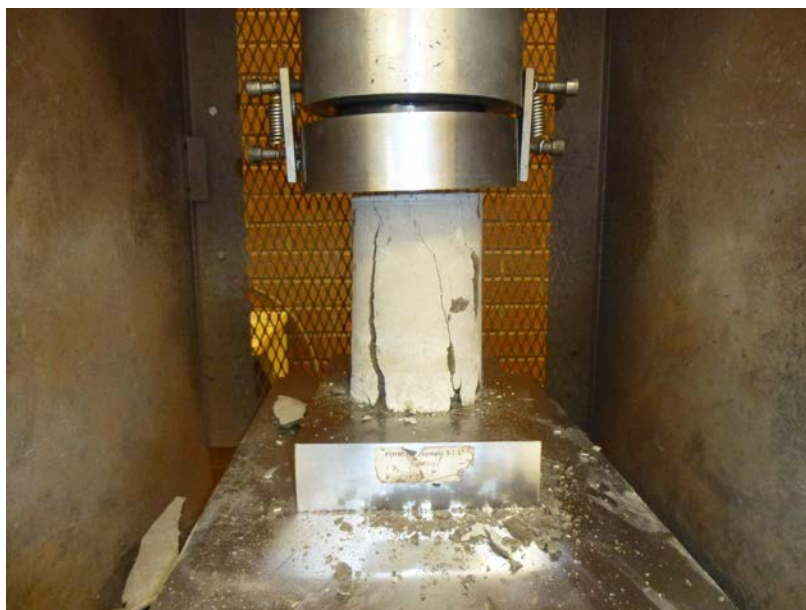
Figur 14 – Trykktesting av betong
