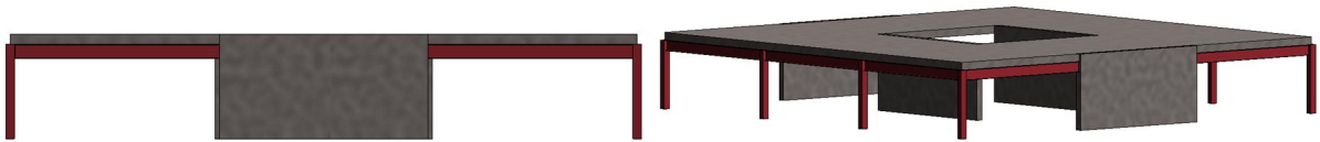
Figur 2.12 - Skivesystemet i xz-planet og i 3D, én etasje
