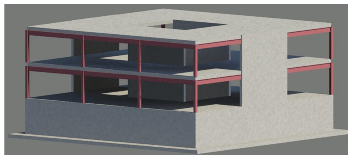
Figur 2.11 – Eksempelbygget i 3D, illustrert i Revit Structure
