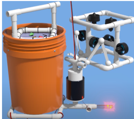
Figur 8: Ved at ROV-en fjerner støpselet fra søppelbøtta vil lyset slukkes. Videre i oppgaven fjerner man fangstposen med objekter i, for å så returnere med en ny fangstpose. Hentet fra [80]
