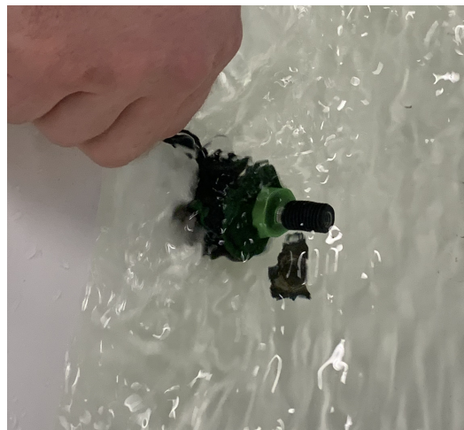
Figur 10.3: Motor for rotasjon av klype, plassert under vann i samme test som figur over.
