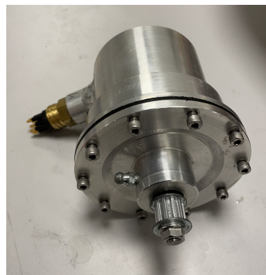
(b) Viser Nema 23 med vanntett kapsel.
