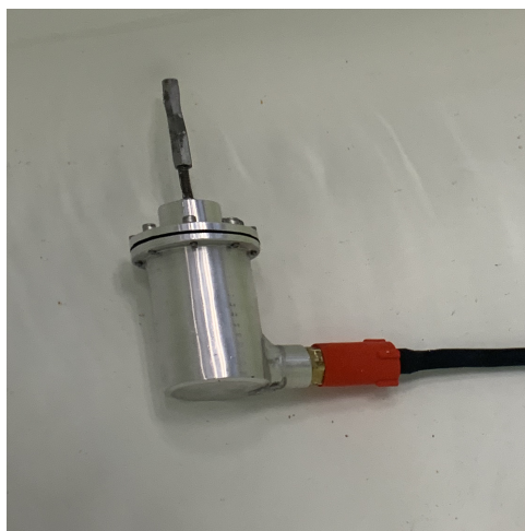
Figur 10.2: Motor for klype-funksjon, plassert under vann i samme test som figur over.
