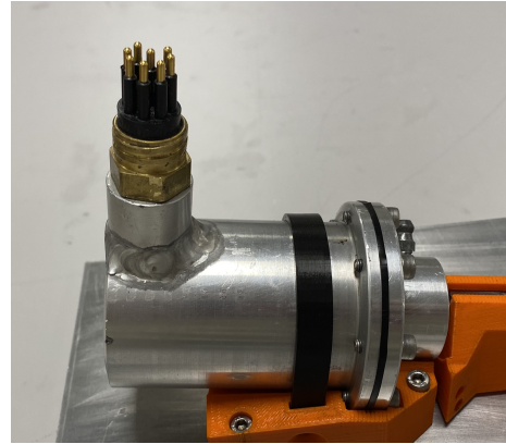
(b) Viser Nema 14 med vanntett kapsel.
