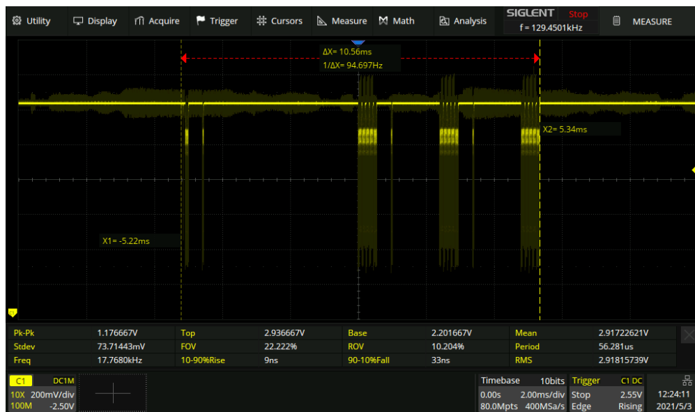
Figur 5.1.5: Skop bilde av SPI SDA mellom mikrokontroller og LTC6820.
