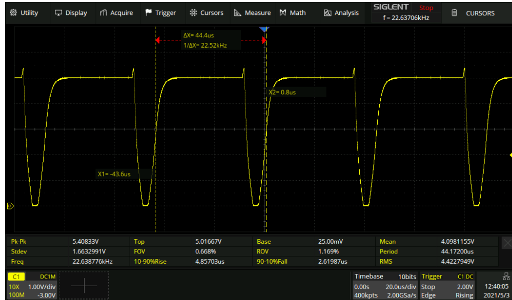
Figur 5.1.3: Skjerm bilde av PWM-signal til styring av vifter.
