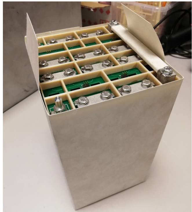
(b) Fullstendig batterisegment med montert skillevegg og innpakket av isoleringsmaterialet 0.4 mm Nomex 410 [3].
