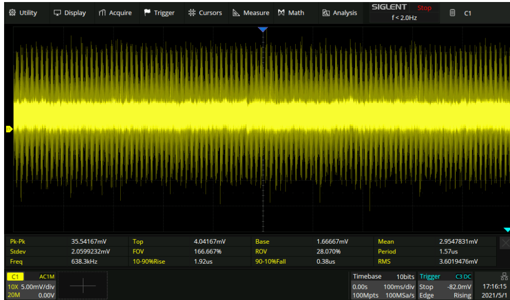
Figur 5.1.8: Skjerm bilde av støy på 6.5 V forsyningsspennning.
