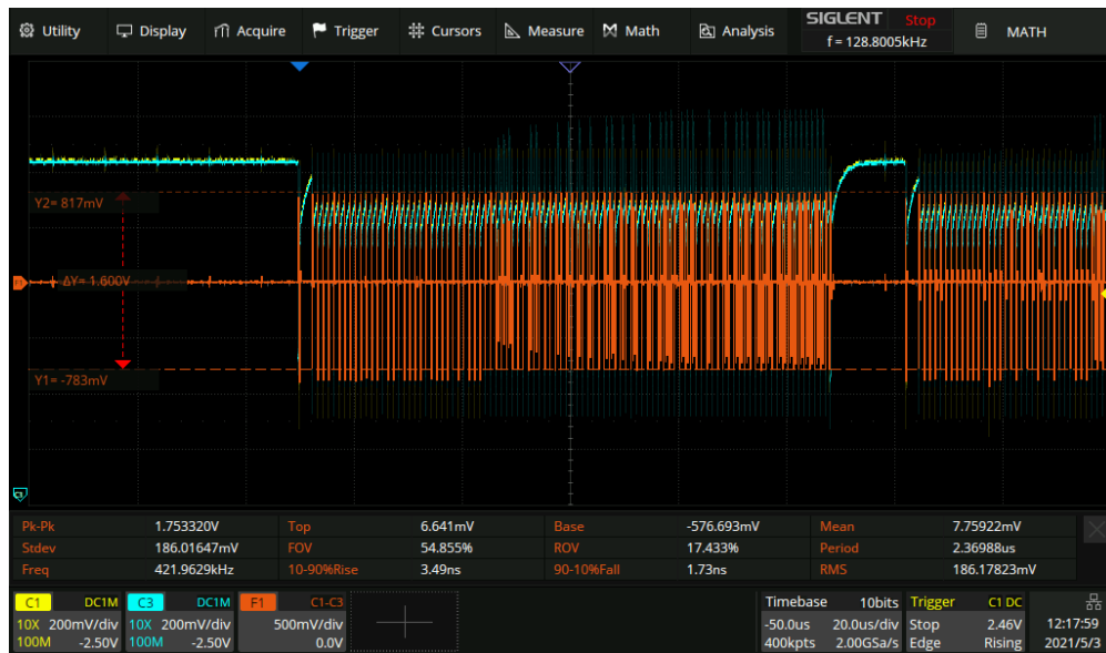
Figur 5.1.4: Skjerm bilde av isoSPI-signaler på masterkort. (CH1:IP på LTC6820, CH2: IM på LTC6820, F1: differanse mellom IP og IM)
