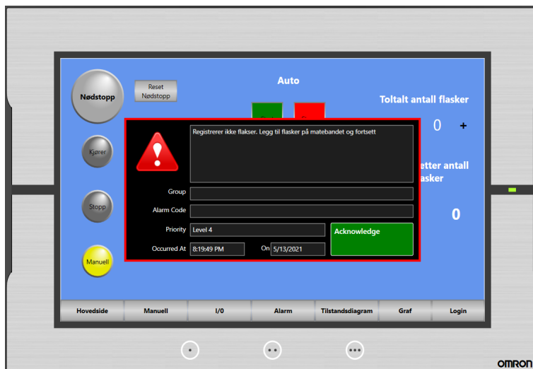
Figur 4.22: Alvorlige alarmer vil dukke opp som en pop-up skjerm uavhengig av hvilken side som vises.
