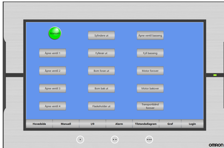
Figur 4.19: Denne siden brukes til manuellkjøring. Den grønne bit-lampen viser at programmet står i manuell. Hensikten er å kunne testkjøre og feilsøke enkelte komponenter.
