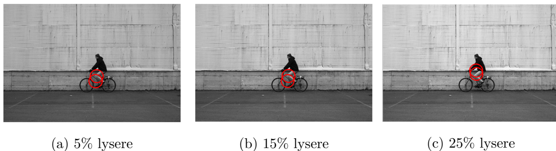
Figur 4.11: BRISK-detektoren ved 5%, 15% og 25 % lysendring. De røde sirklene representerer hjulene funnet ved Hough-transformen.
