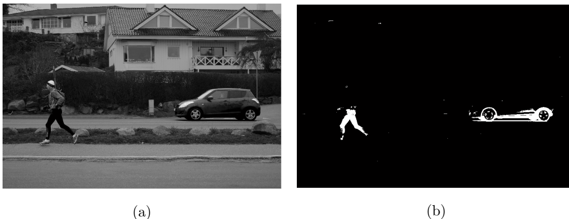
Figur 2.30: Figuren viser bildet før og etter bakgrunnssubtraksjon.
