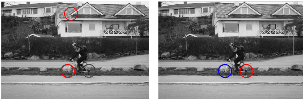
(c) De 2 mest fremtredende sirklene funnet ved Hough-transformen. (d) Sykkel detektert gitt størrelsesforhold og avstand mellom sirklene.
