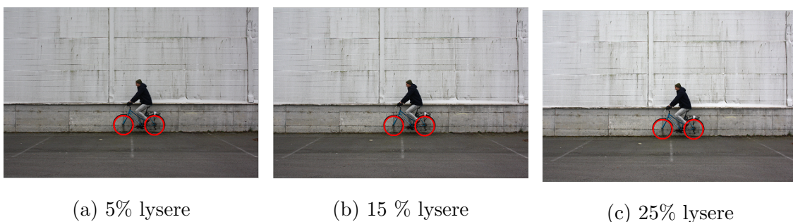
Figur 4.13: SUSAN-detektoren ved 5%, 15% og 25 % lysendring. De røde sirklene representerer hjulene funnet ved Hough-transformen.
