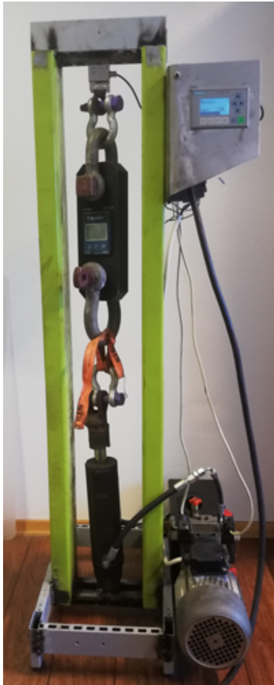
Figur 5.3: Kontroll av last mot ekstern veiecelle
