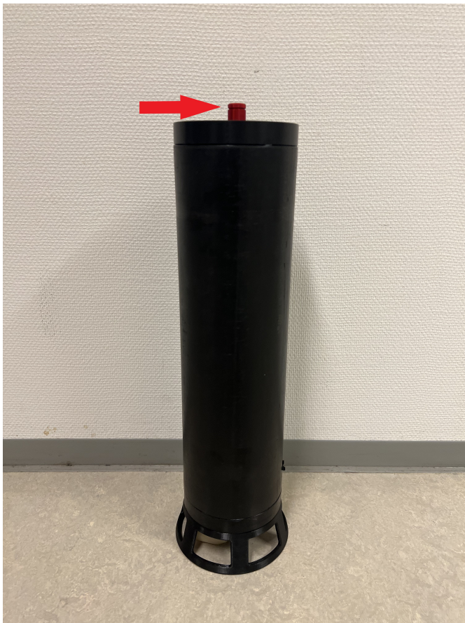
Figur 108: Flyteren med sylinder og endelokk.
